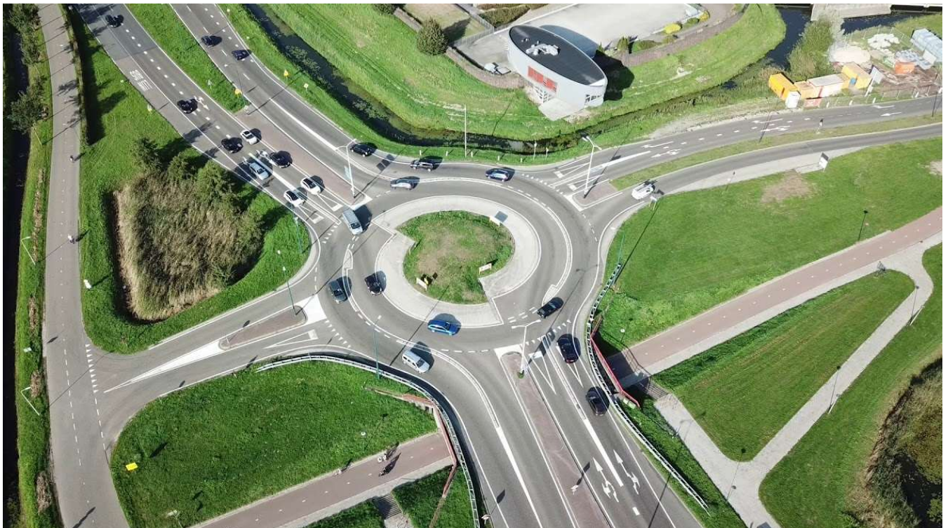
Slika 26. Prvi turbo kružni tok u Hrvatskoj (Osijek) [9]
