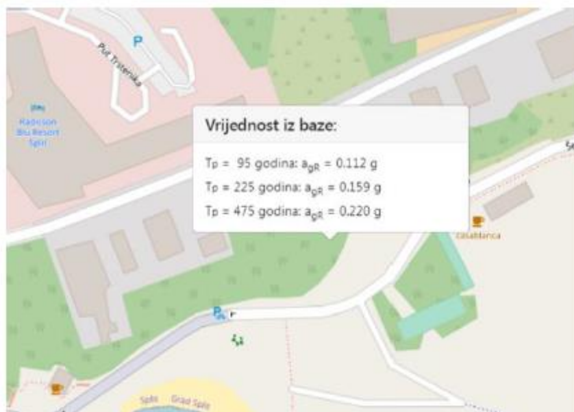
Slika 6. Očitavanje iznosa vršnih horizontalnih ubrzanja tla tipa "A" iz karte potresnih područja Republike Hrvatske
