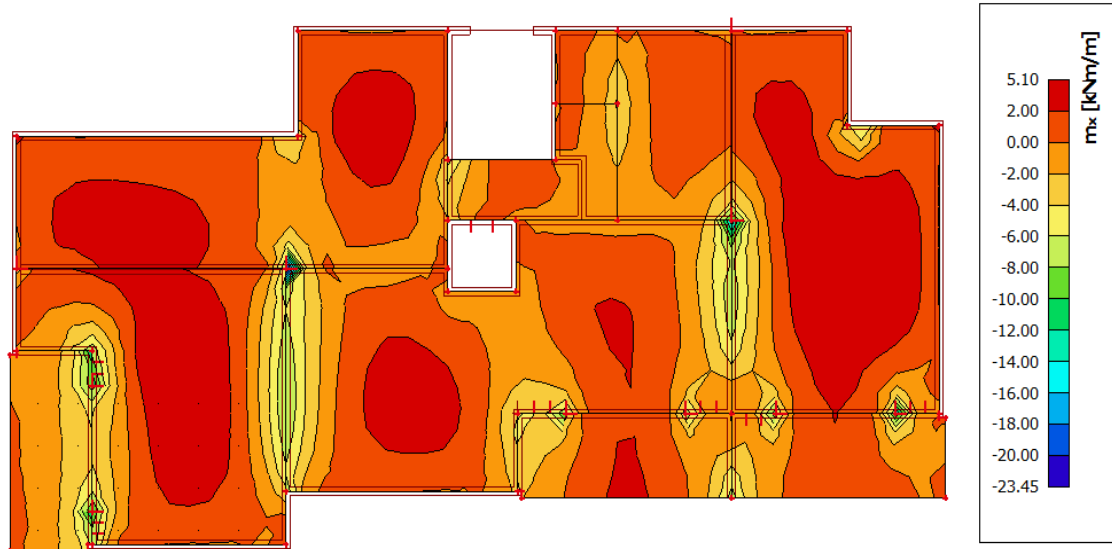
Slika 4.46. Moment savijanja M_x
