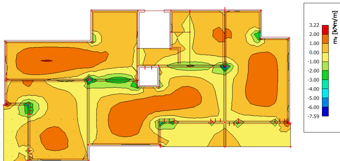
Slika 4.53. Moment savijanja M_y
