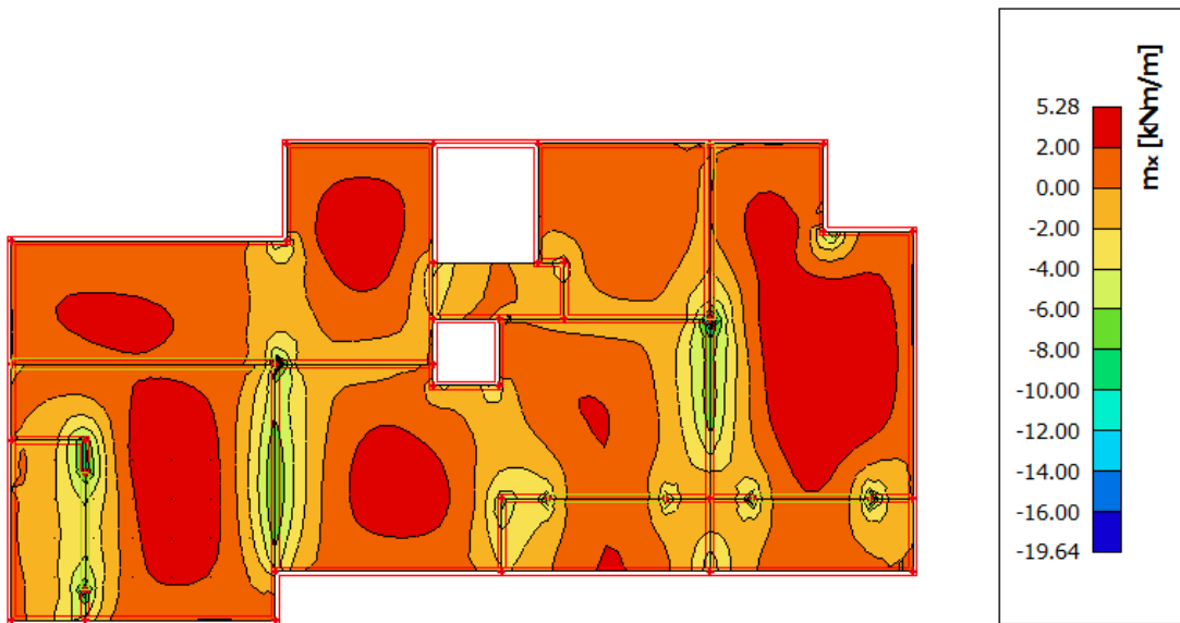
Slika 4.22. Moment savijanja M_x
