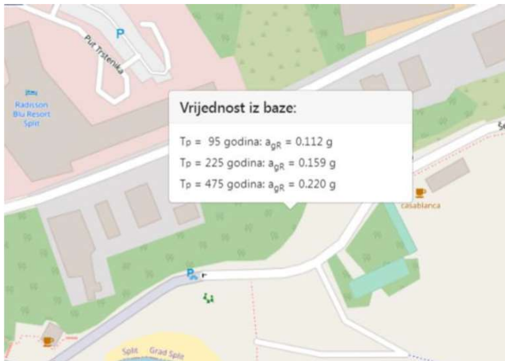
Slika 18. Očitanje iznosa vršnih horizontalnih ubrzanja tla tipa "A" iz karte potresnih područja Republike Hrvatske
