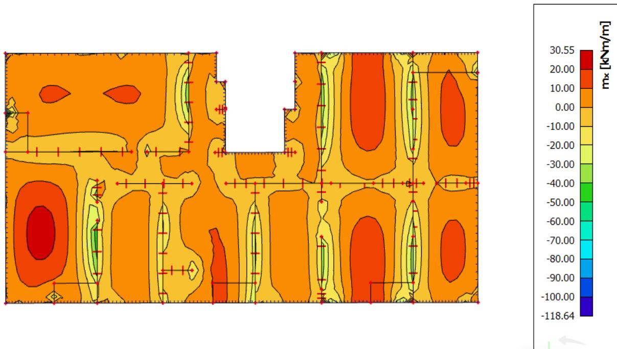
Slika 6.32. Prikaz momenata savijanja na ležajevima  $M_x$  – GSN1
