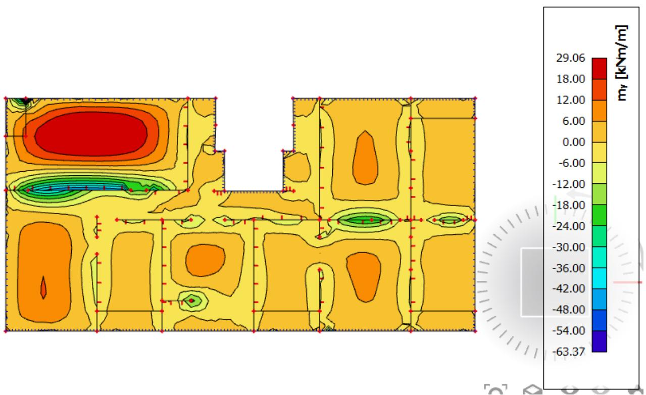
**Slika 6.33.** Prikaz momenata savijanja na ležajevima  $M_y$  – GSN1
