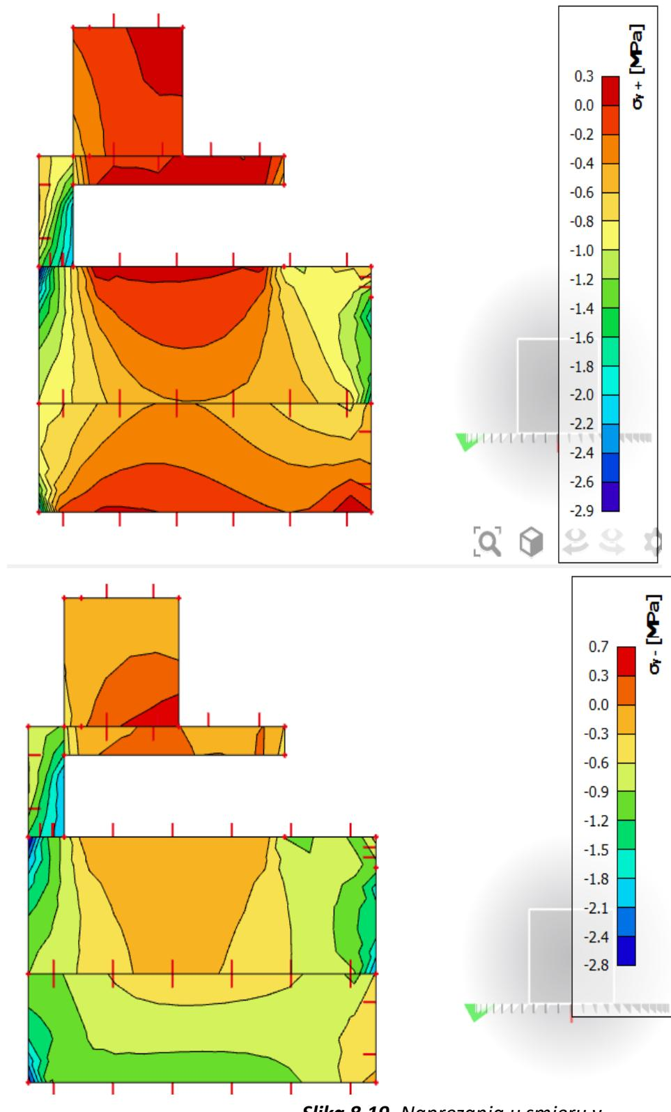
Slika 8.19. Naprezanja u smjeru y
