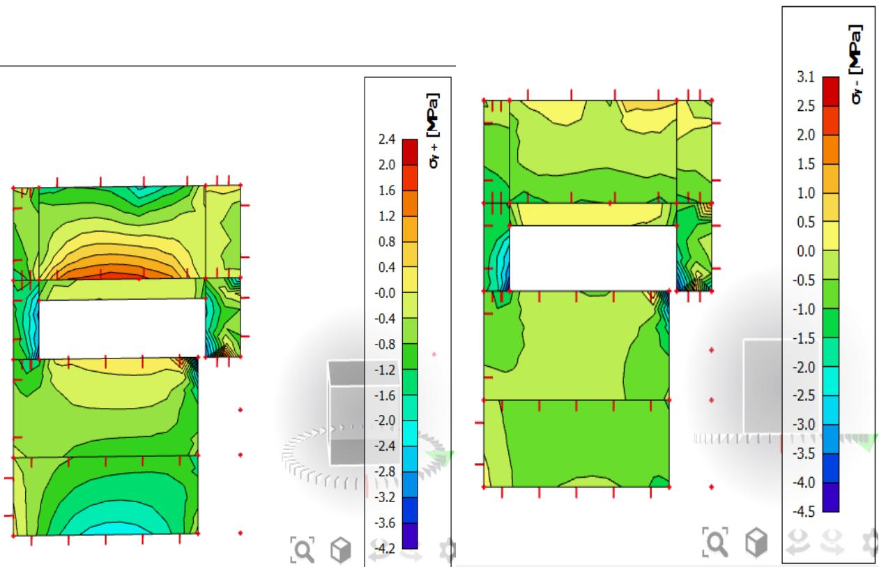
Slika 8.24. Naprezanja u smjeru y
