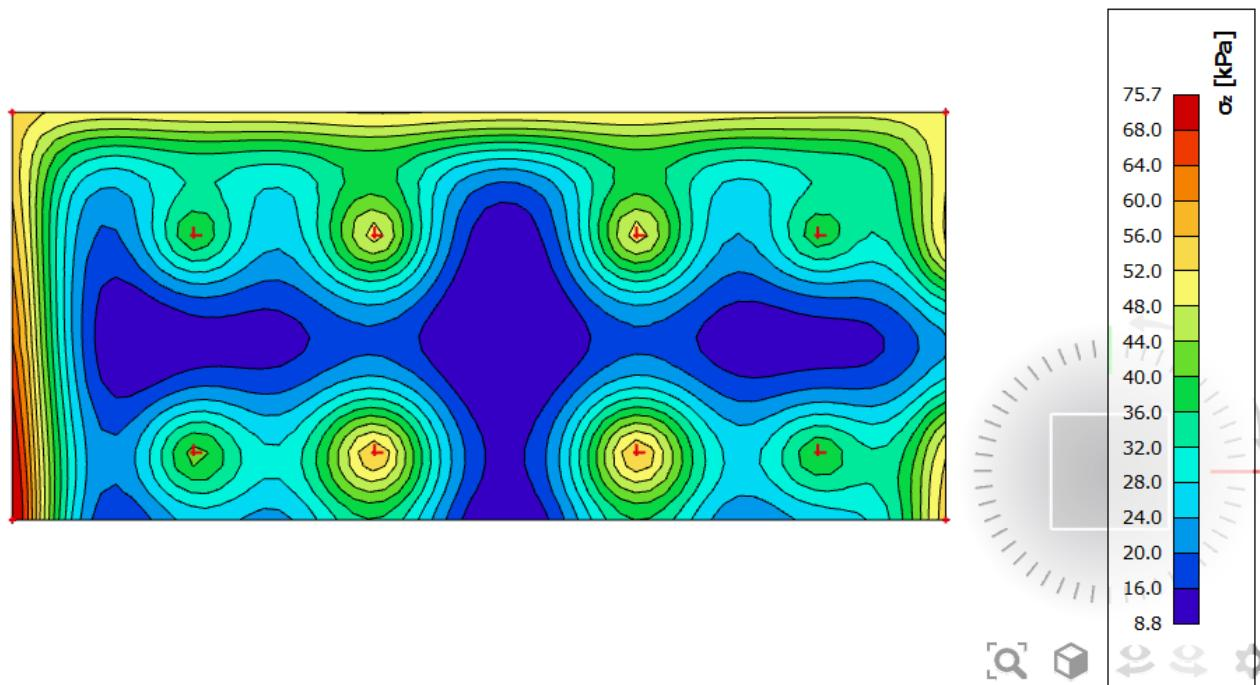
**Slika 10.1.** Naprezanja u tlu za kvazistalnu kombinaciju 1,0G+1,0Q
