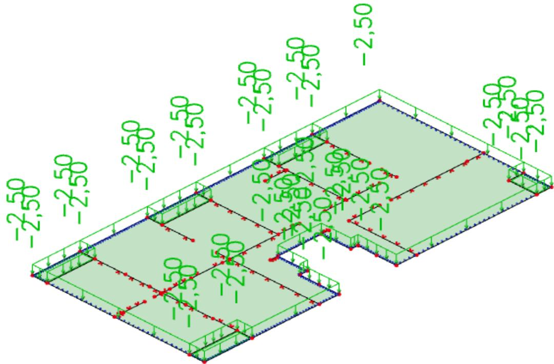
**Slika 6.28.** Dodatno stalno opterećenje ( $kN/m^2$ )
