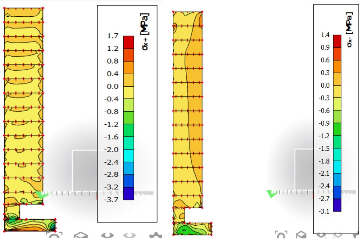
**Slika 8.35.** Naprezanja u smjeru x
