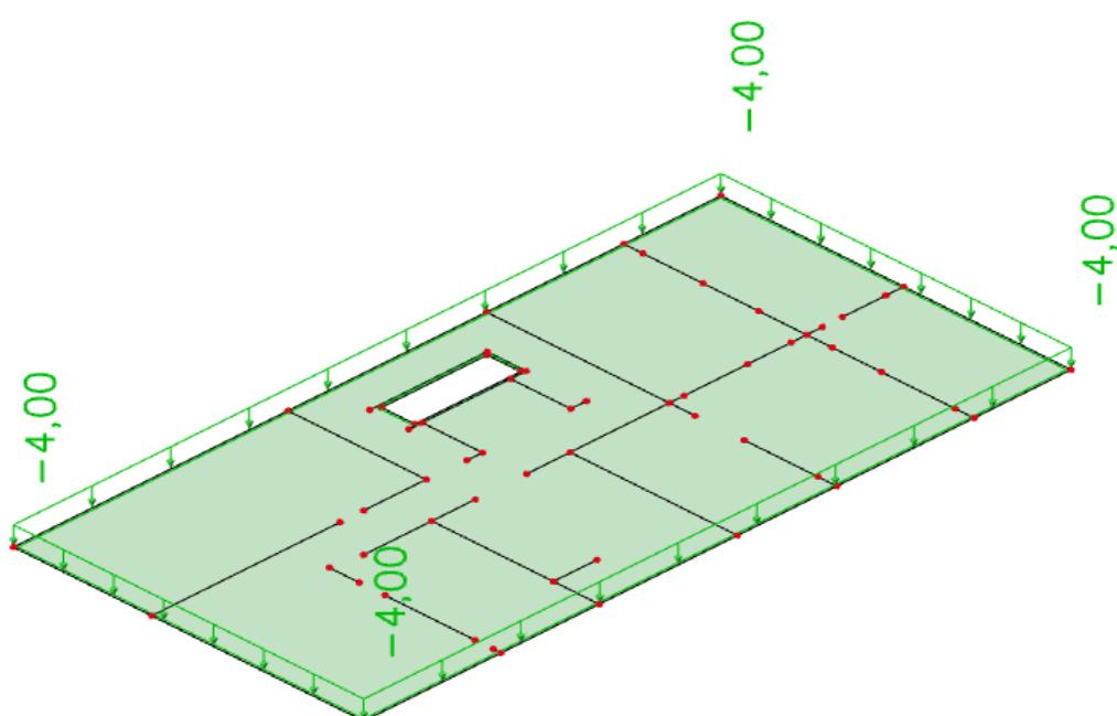
*Slika 6.30. Korisno opterećenje ( $\text{kN}/\text{m}^2$ )*
