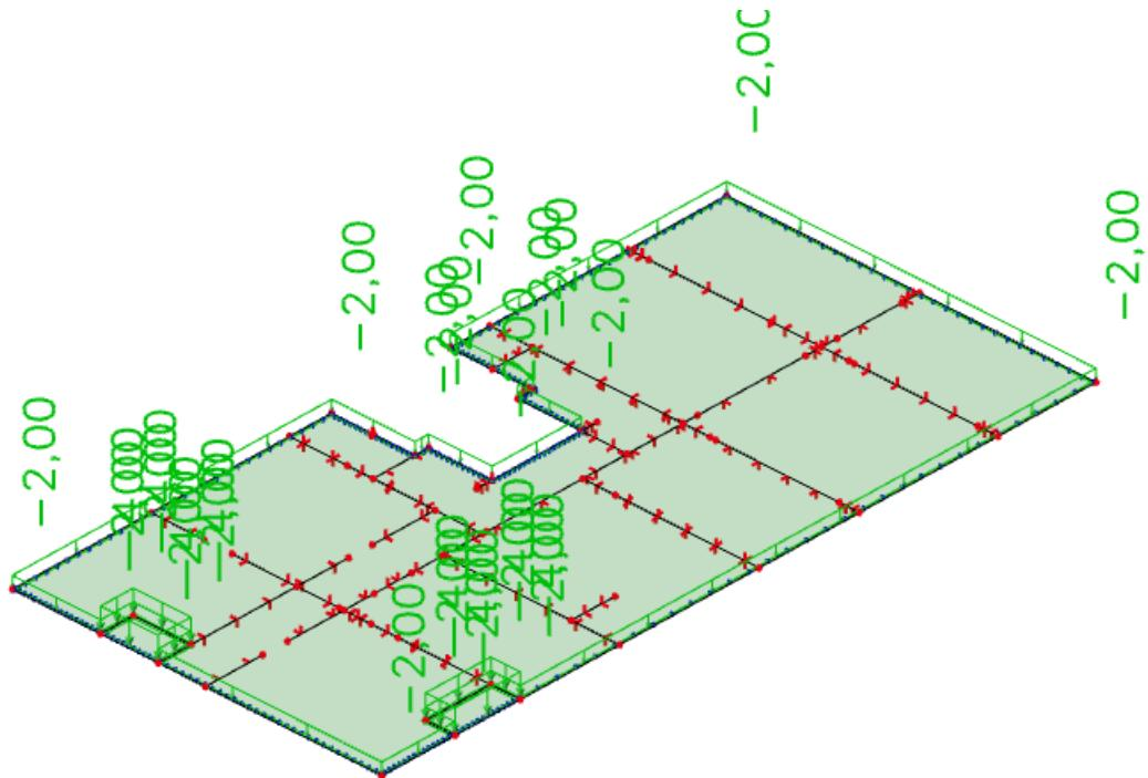
*Slika 6.20. Promjenjivo opterećenje ( $\text{kN}/\text{m}^2$ )*
