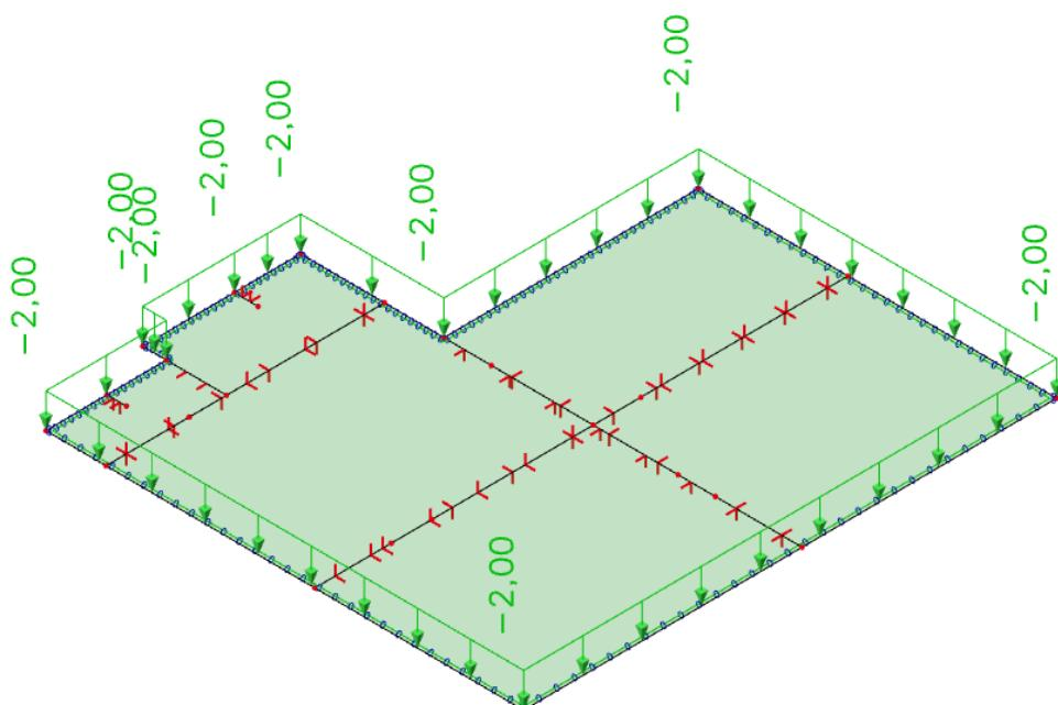
*Slika 6.2. Korisno opterećenje ( $\text{kN}/\text{m}^2$ )*
