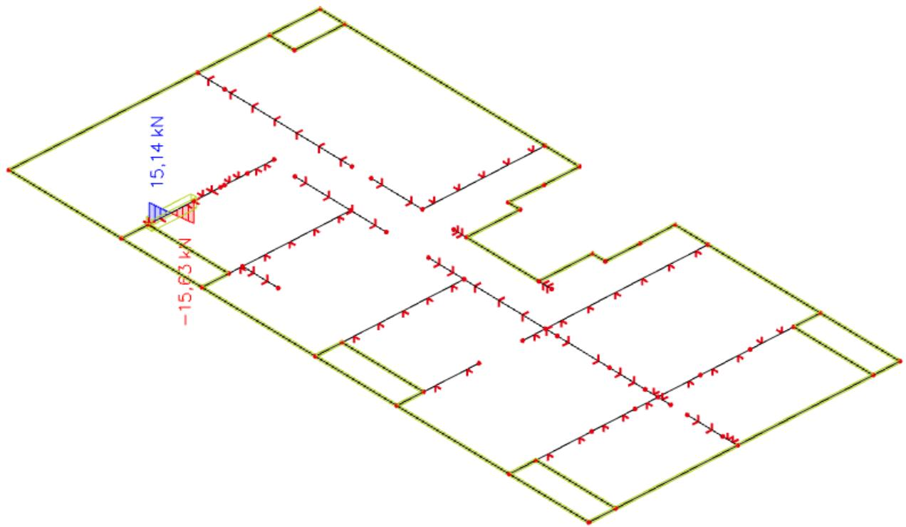
**Slika 7.8.** Prikaz poprečnih sila za grede pozicije 400,500,800,1100,1200,1300
