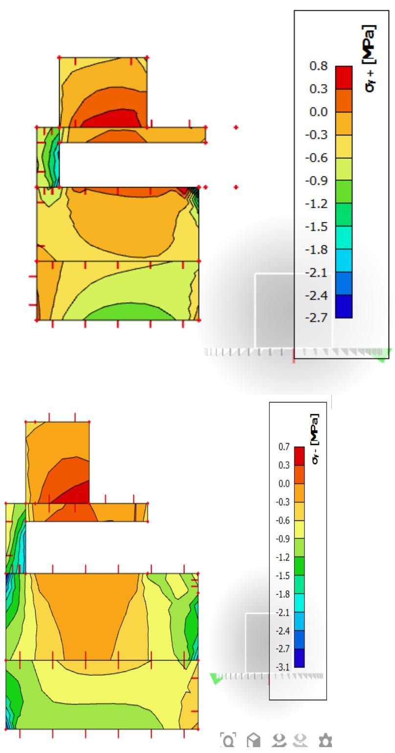
Slika 8.17. Naprezanja u smjeru y
