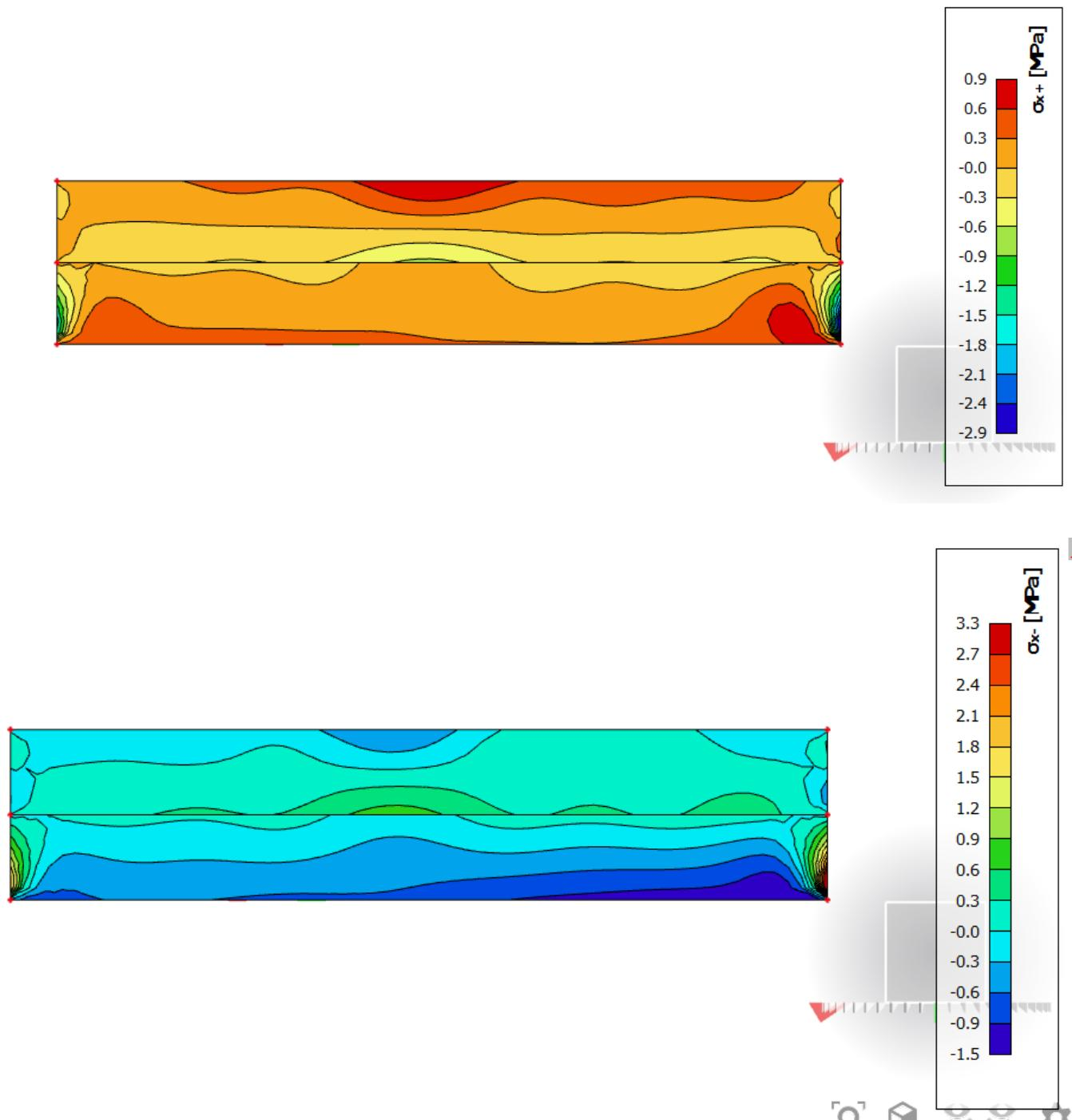
**Slika 8.31.** Naprezanja u smjeru x
