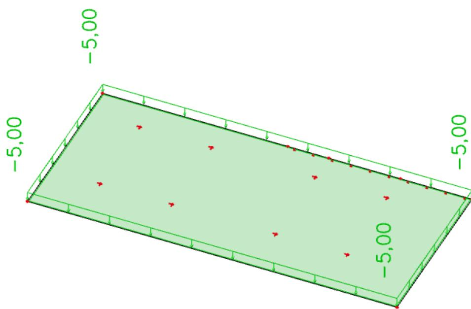
*Slika 6.43.* Korisno opterećenje ( $\text{kN}/\text{m}^2$ )
