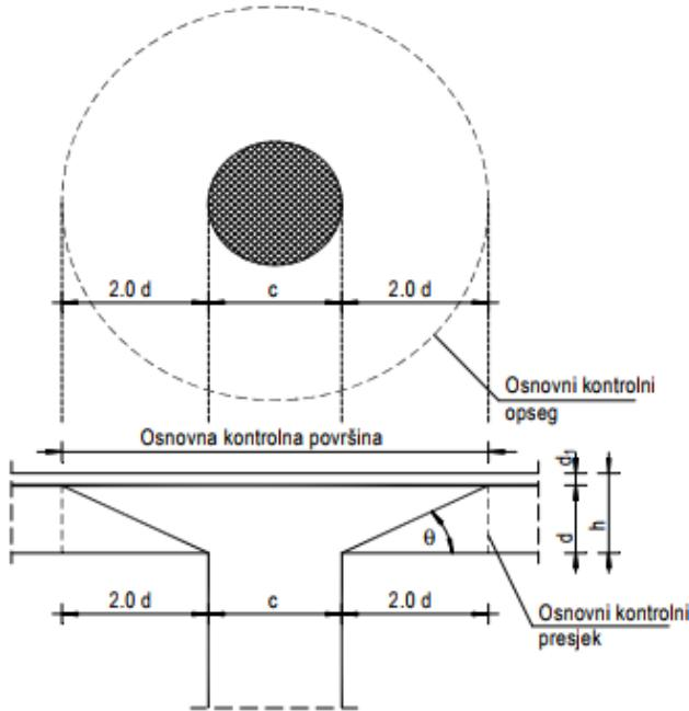
**Slika 8.13 Proboj ploče**
