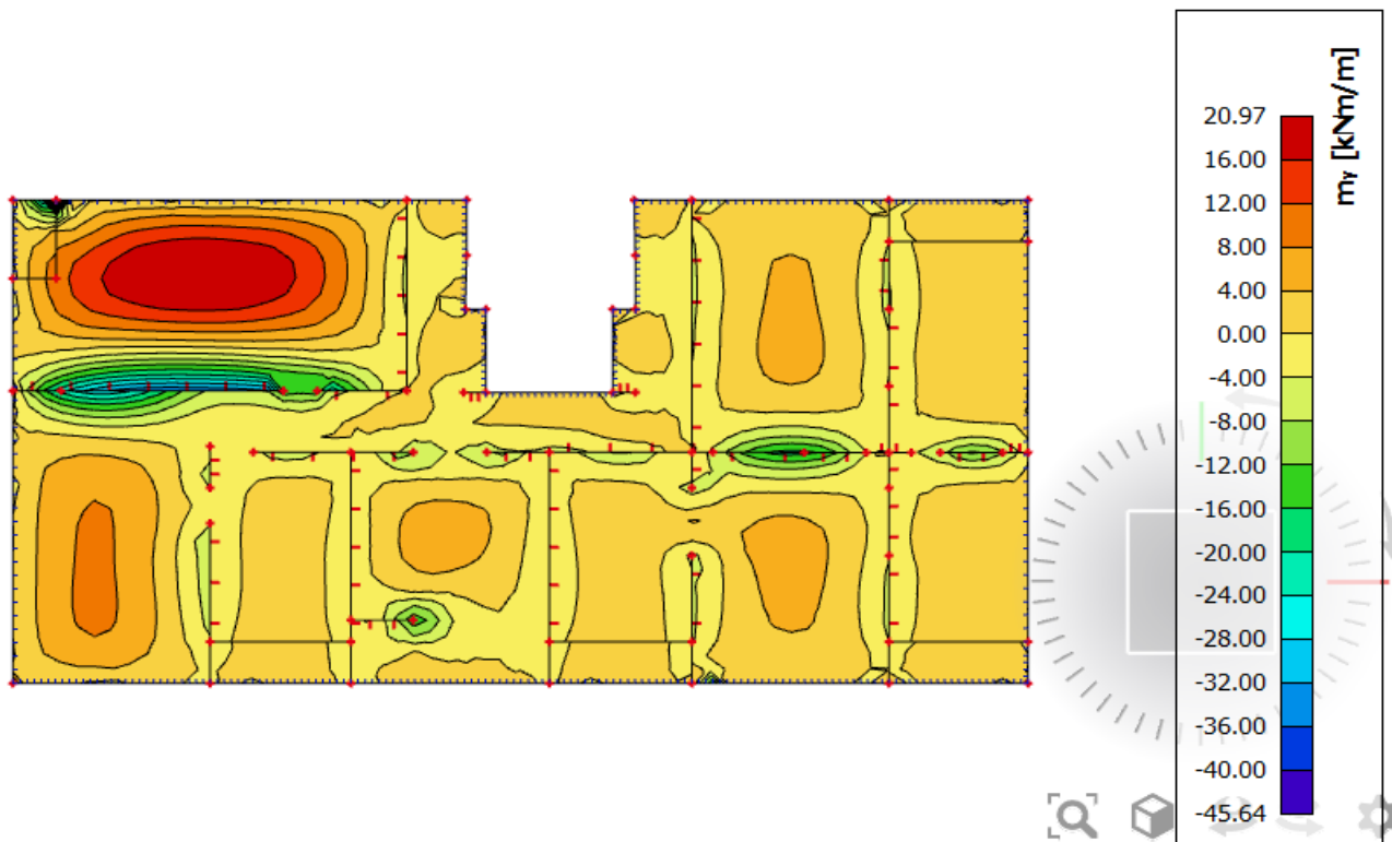
Slika 6.35. Maksimalni momenti savijanja M_y , za kombinaciju GSU
