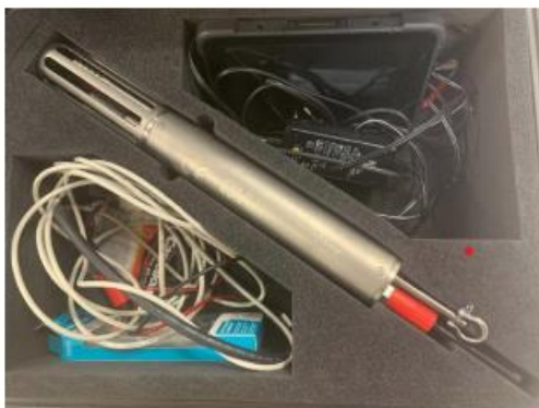
Slika 7. CTD/DO sonda za vertikalno profiliranje parametara: tlak, salinitet, temperatura i otopljeni kisik [42]
