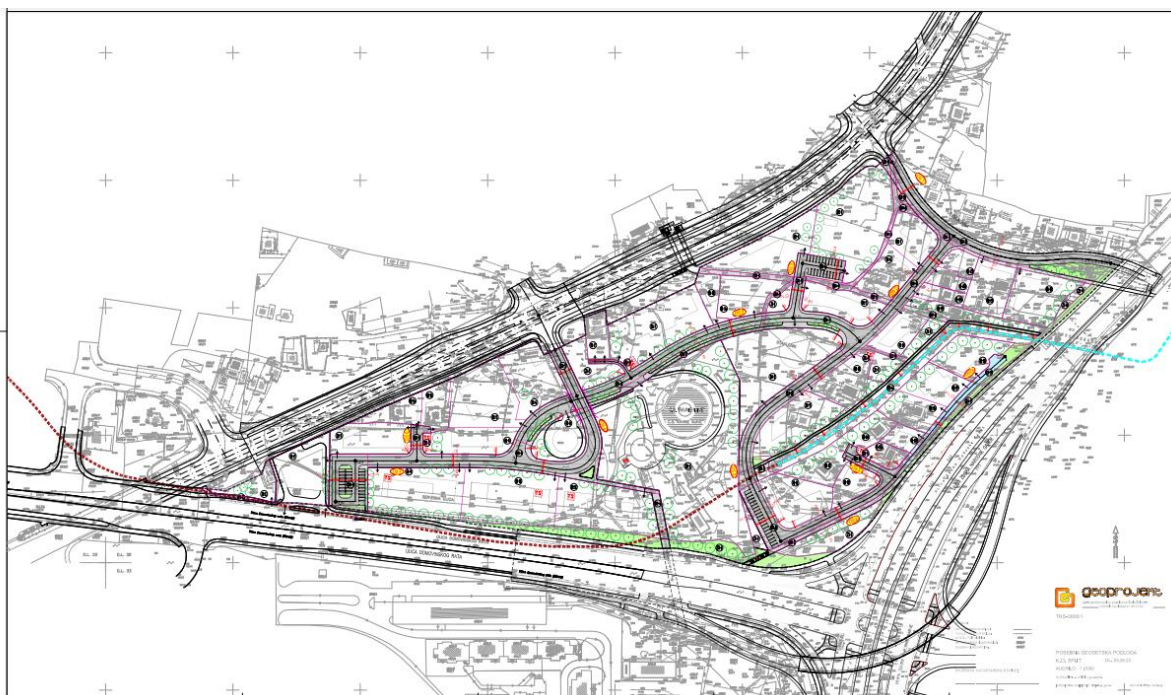
Slika 10. Detaljni plan uređenja za dio obuhvata Pojedinačnog zahvata P26 - sjeverno od križanja ulica Domovinskog rata i Zbora narodne garde-prometna, infrastrukturna i telekomunikacijska mreža [7]
