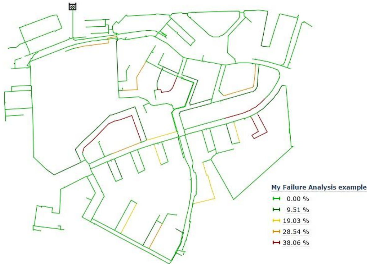
Slika 37. Prikaz analize kvarova na vodoopskrbnoj mreži (uzeto iz AWARE-P softvera) [7]
