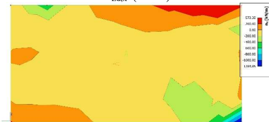
C3x) Proračunske vlačne sile za ANV 1: n_{Ed,x} (kN/m)
