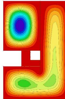
Momenti savijanja M_{sd,x} (kNm/m) – GSN
