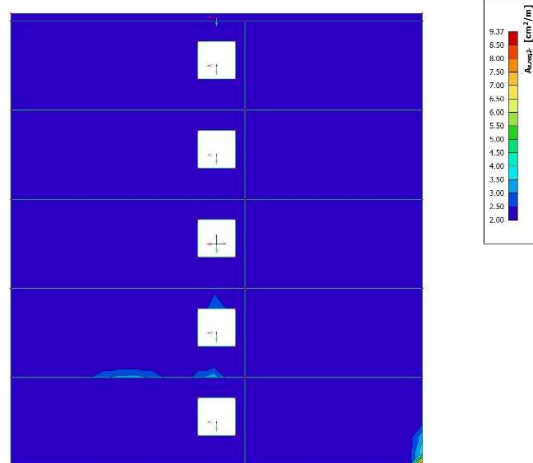
C4y) Proračunska armatura y za ANV 1: A_{s,y} (cm 2 /m) - stražnja strana
