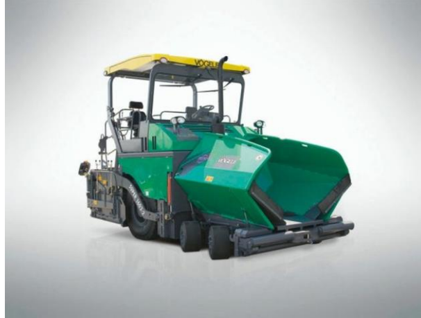
Slika 12. Finišer na kotačima VOGELE SUPER 1603 - 3i [8]
