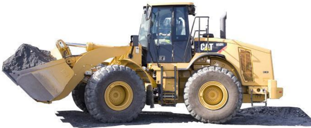
Slika 10. Utovarivač Caterpillar 950H [8]
