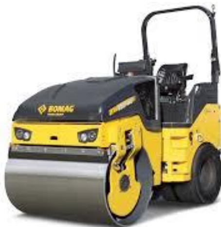
Slika 11. Vibrovaljak Bomag BW 138 AC-5 [8]
