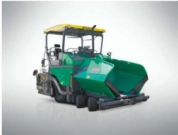
Slika 12. Finišer na kotačima VOGELE SUPER 1603 - 3i [8]
