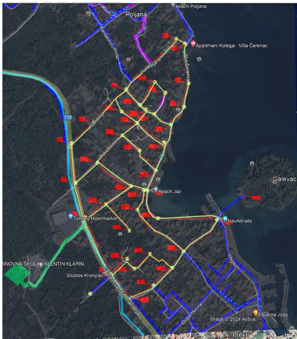
Slika 4. Preklop odabranog djela vodovodne mreže sa satelitskom podlogom Google Earth
