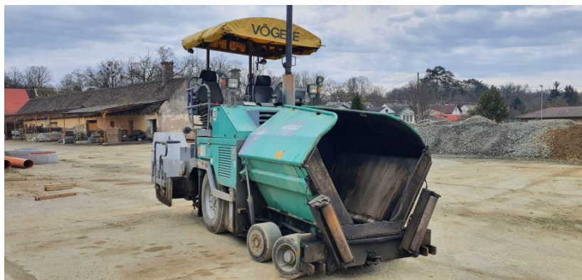
Slika 16. Finišer za asfaltiranje VOGELE S1203 [9]
