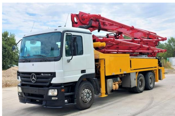
Slika 15. Mercedes actros 2631/6x4/45 SA PUTZMEISTER [8]
