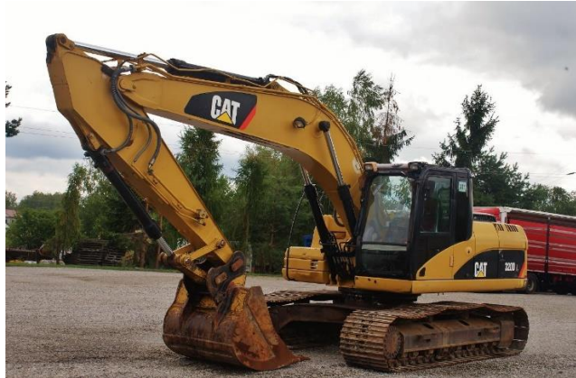
Slika 8. Jaružalo s dubinskom lopatom [1]
