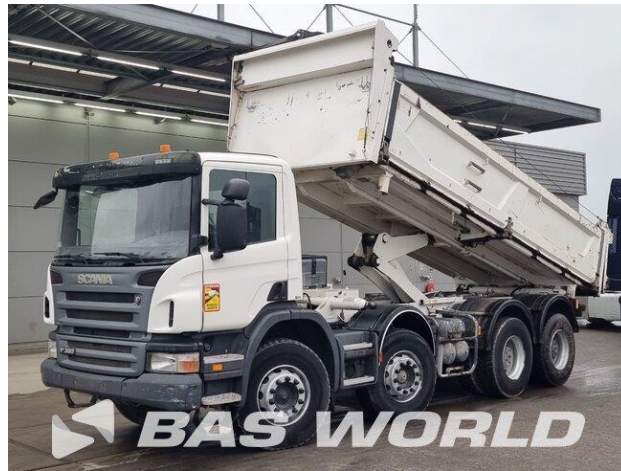
Slika 17. Kamion kiper za asfaltiranje SCANIA P380 8x4 [10]
