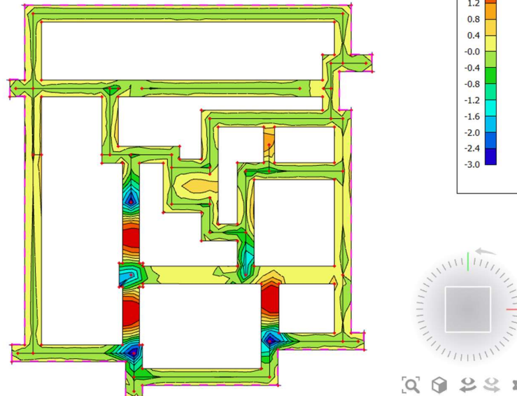
Dijagram 40.. Prikaz maksimalnih naprezanja u temeljima za kombinaciju opterećenja GSU
