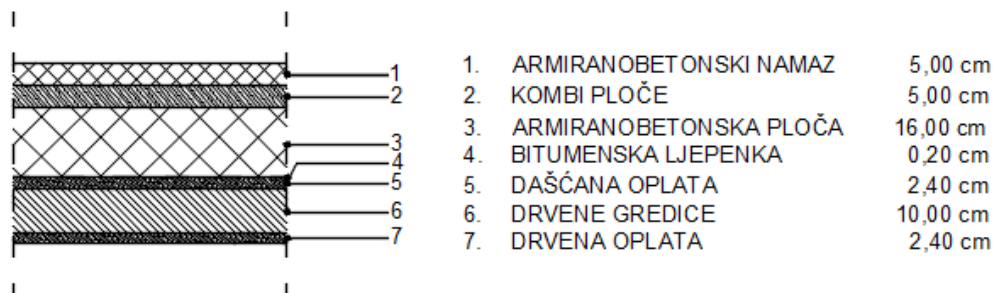
Slika 25: Detalj- međukatna konstrukcija
