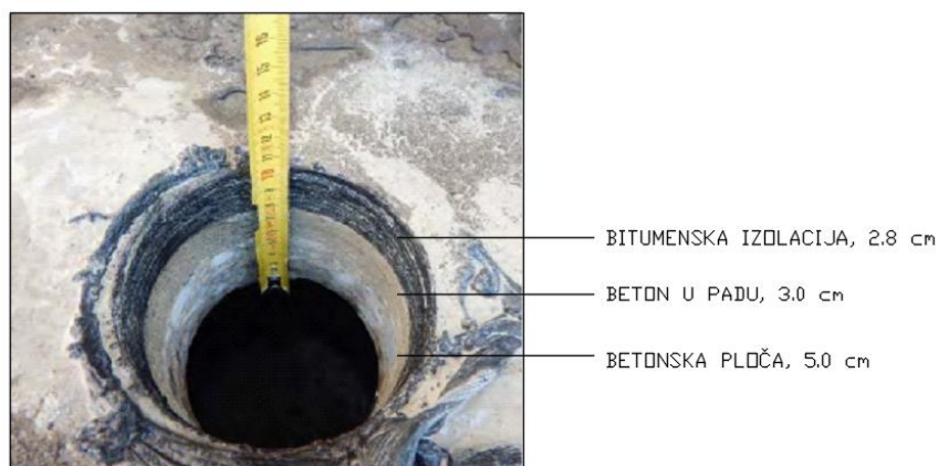
Slika 13: Fotografija uzorka pozicije 1 s definiranim pripadajućim slojevima [13]
