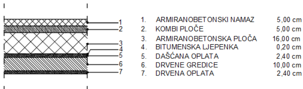
Slika 25: Detalj- međukatna konstrukcija
