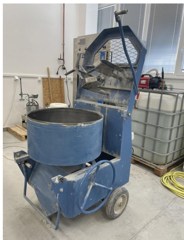
Slika 20. Laboratorijska miješalica za beton
