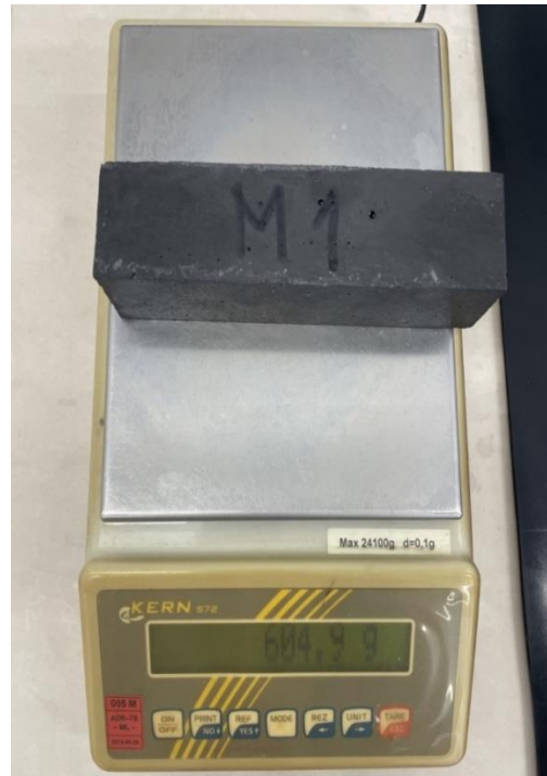
Slika 26. Vaganje uzorka beton
