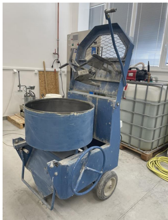
Slika 20. Laboratorijska miješalica za beton
