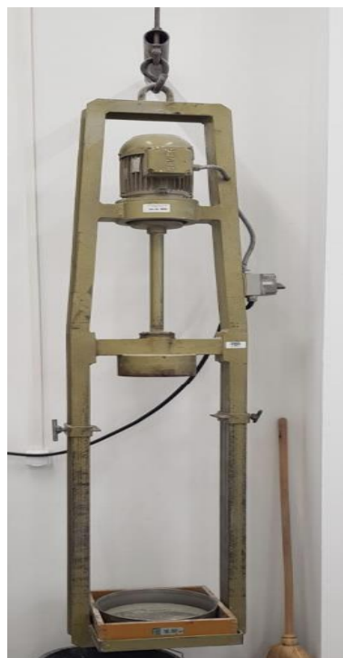
Slika 15. Uređaj za prosijavanje agregata
