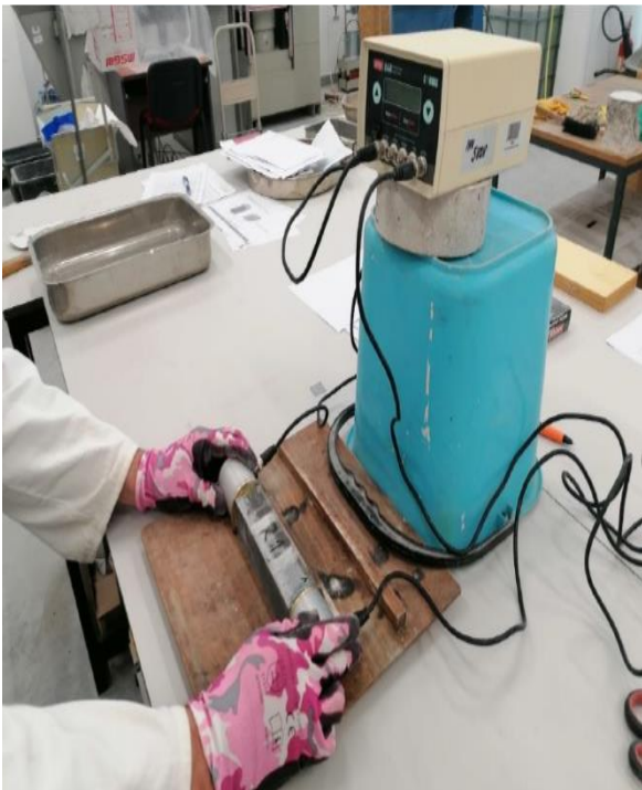
Slika- 25. Mjerenje brzine ultrazvuka
