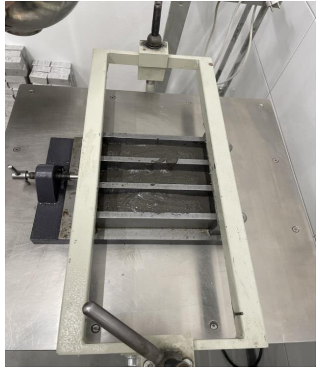
Slika 22. Uzorci UHPC na vibrostolu
