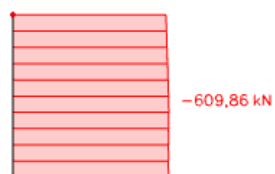
Slika 13.24. Pripadna uzdužna sila za izvanrednu kombinaciju
