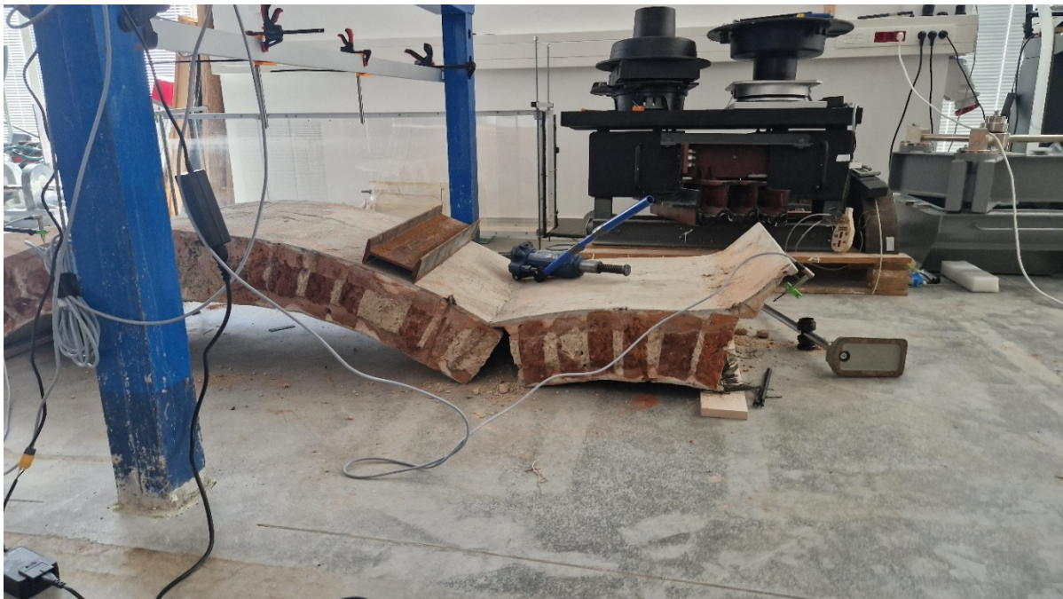
Fotografija 2.22 – Slom svoda
