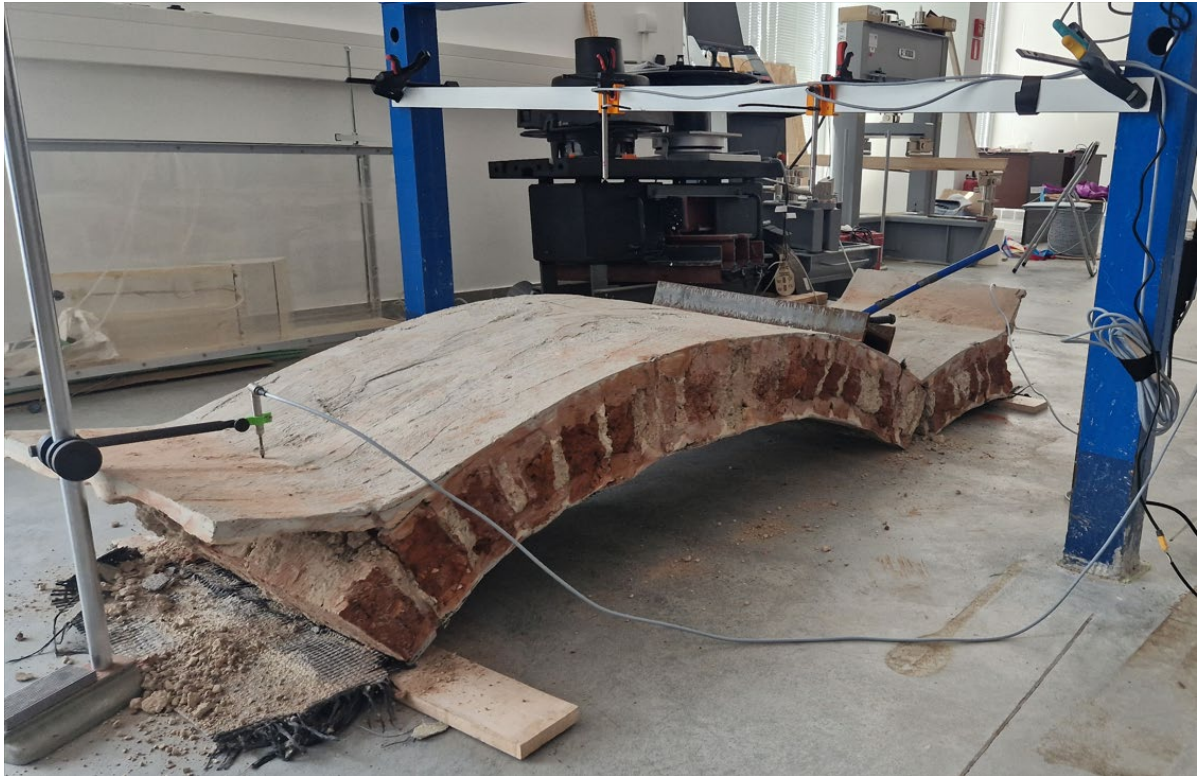
Fotografija 2.21 – Slom svoda
