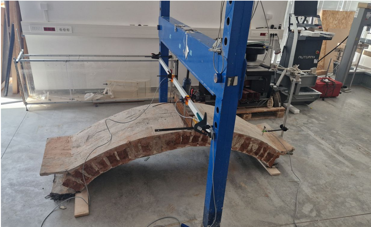
Fotografija 2.13 – Postavljanje senzora deformacije i progiba
