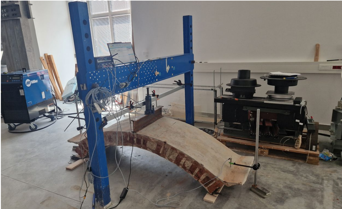
Fotografija 2.15 – Postavljanje pojačala i konvertera te računala
