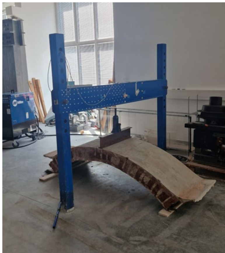
Fotografija 2.12 – Postavljanje hidrauličke dizalice
