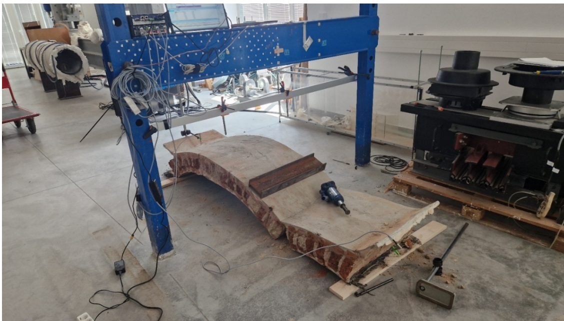
Fotografija 2.20 – Slom svoda
