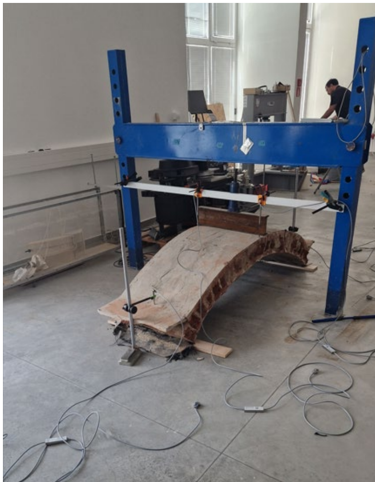
Fotografija 2.14 – Postavljanje senzora deformacije i progiba
