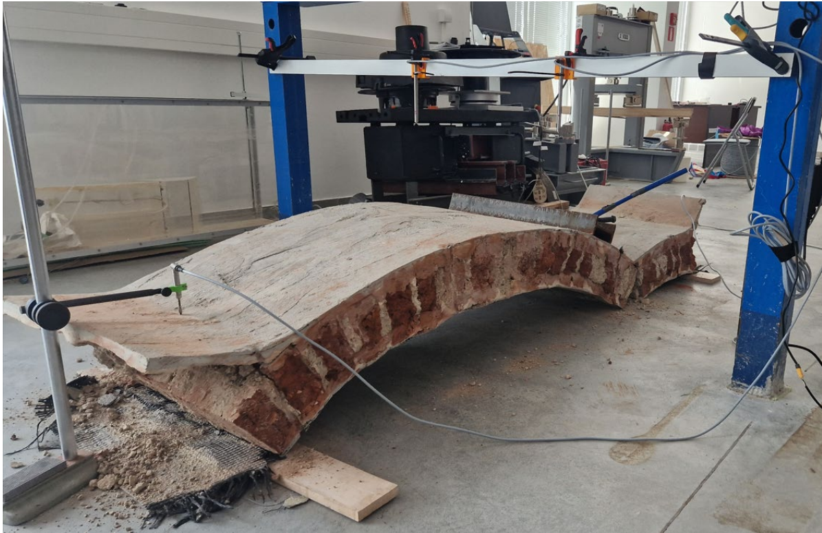
Fotografija 2.21 – Slom svoda
