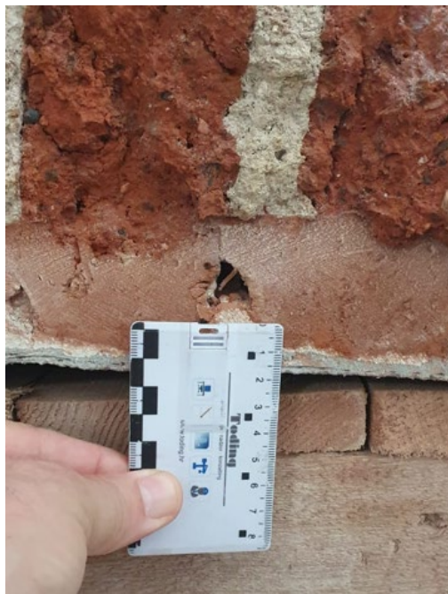
Fotografija 2.7 – Mjerenje debljine sloja karbonskog platna i morta
