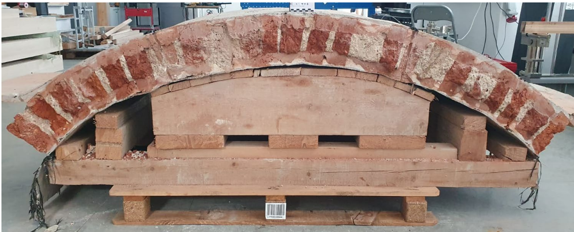
Fotografija 2.1 – Ispitivani svod
