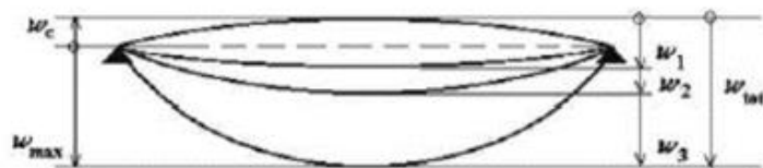
Slika 8.3 Prikaz progiba grede
