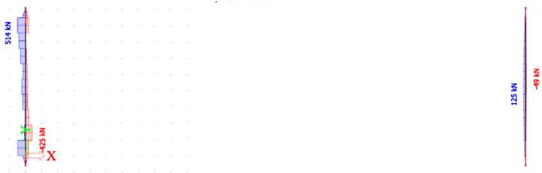
Slika 63. Poprečne sile V_y
