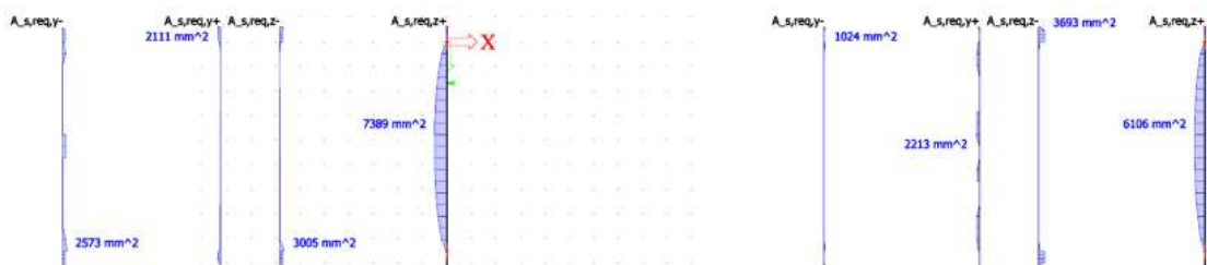
Slika 65. Potrebna uzdužna armatura
