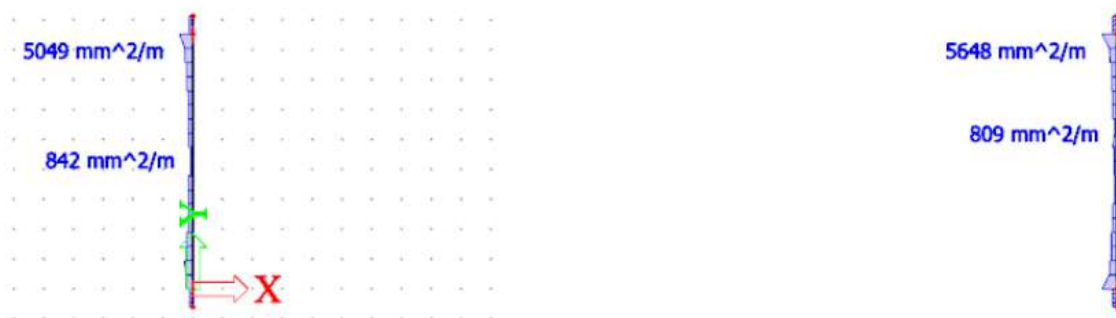
Slika 66. Potrebna poprečna armatura
