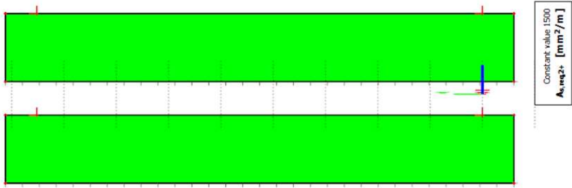
Slika 73. Potrebna vertikalna armatura prema nasipu
