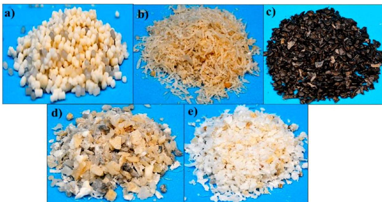
Slika 13. Tipovi recikliranog plastičnog agregata: a) zrno, b) vlakna, c) crne pahuljice, d) miješane pahuljice, e) bijele pahuljice [22]
