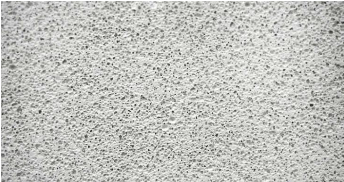
Slika 1. Struktura lakog betona [4]
