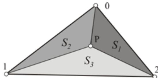
Slika 8. Potencijal  $\varphi$  u točki  $P$  konačnog elementa
