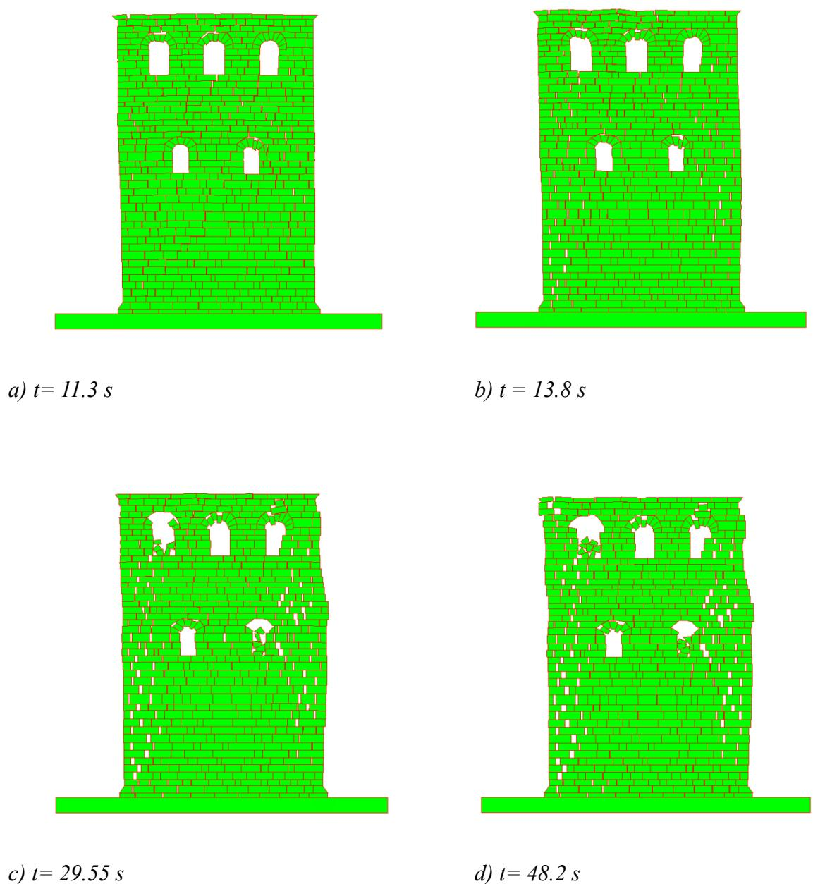
Slika 19. Prikaz deformiranja konstrukcije pri vršnom ubrzavanju tla 2.0 g
