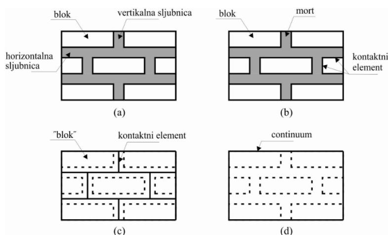
Slika 6. Stupnjevi modeliranja zidanih konstrukcija: a) elementi zidane konstrukcije, b) mikro modeliranje, c) pojednostavljeni mikro modeliranje, d) makro modeliranje
