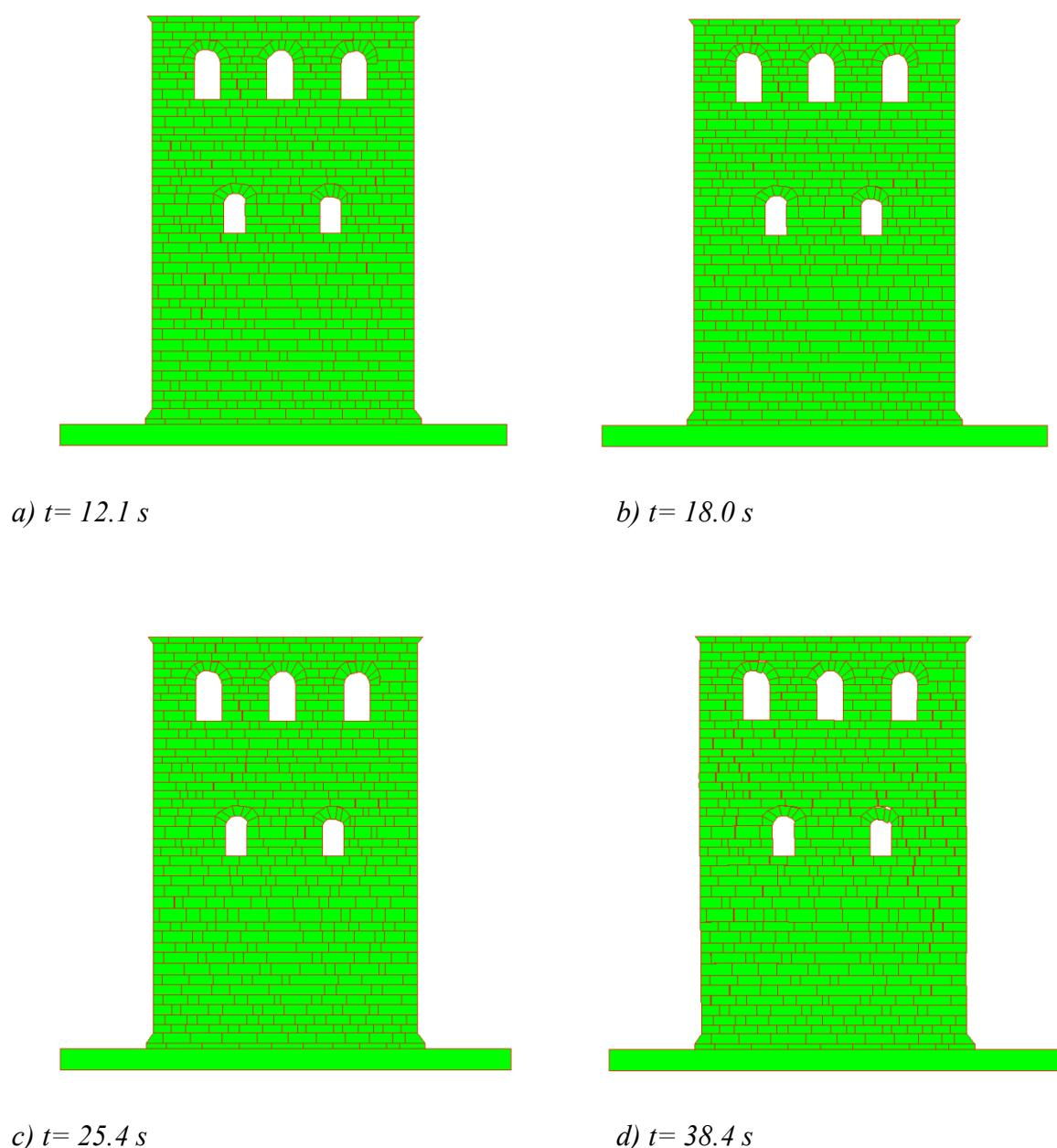
Slika 25. Prikaz deformiranja konstrukcije pri vršnom ubrzavanju tla 3.0 g
