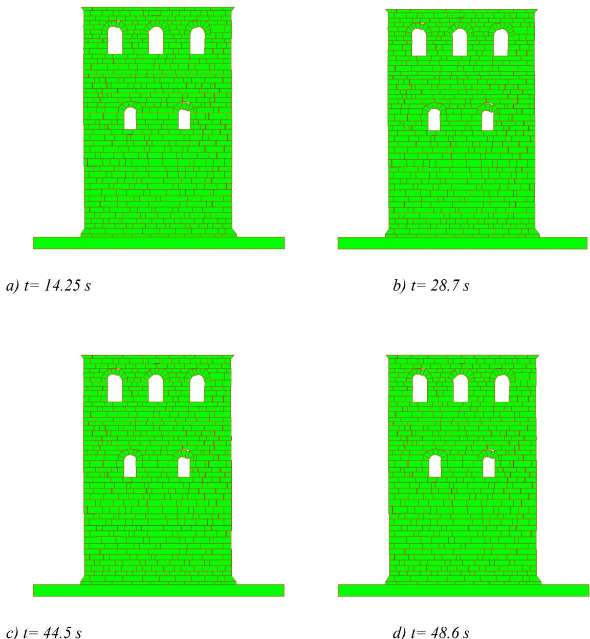
Slika 22. Prikaz deformiranja konstrukcije pri vršnom ubrzavanju tla  $3.0 \text{ g}$
