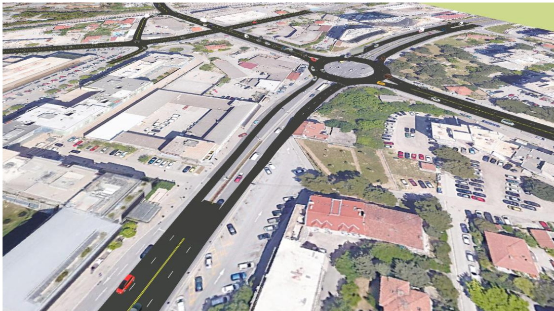
Slika 62. 3D prikaz rekonstrukcije raskrižja pomoću programa Civil 3D
