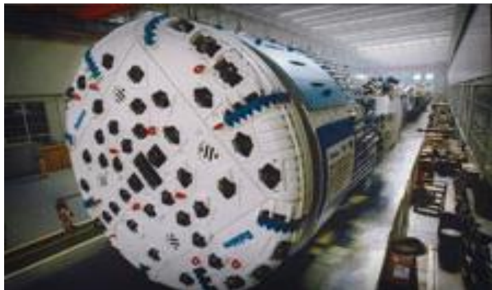
Slika 3. TBM stroj „krtica“ [4]
