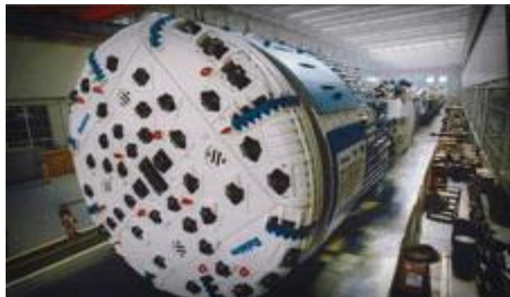
*Slika 3.TBM stroj „krtica“ [4]*
