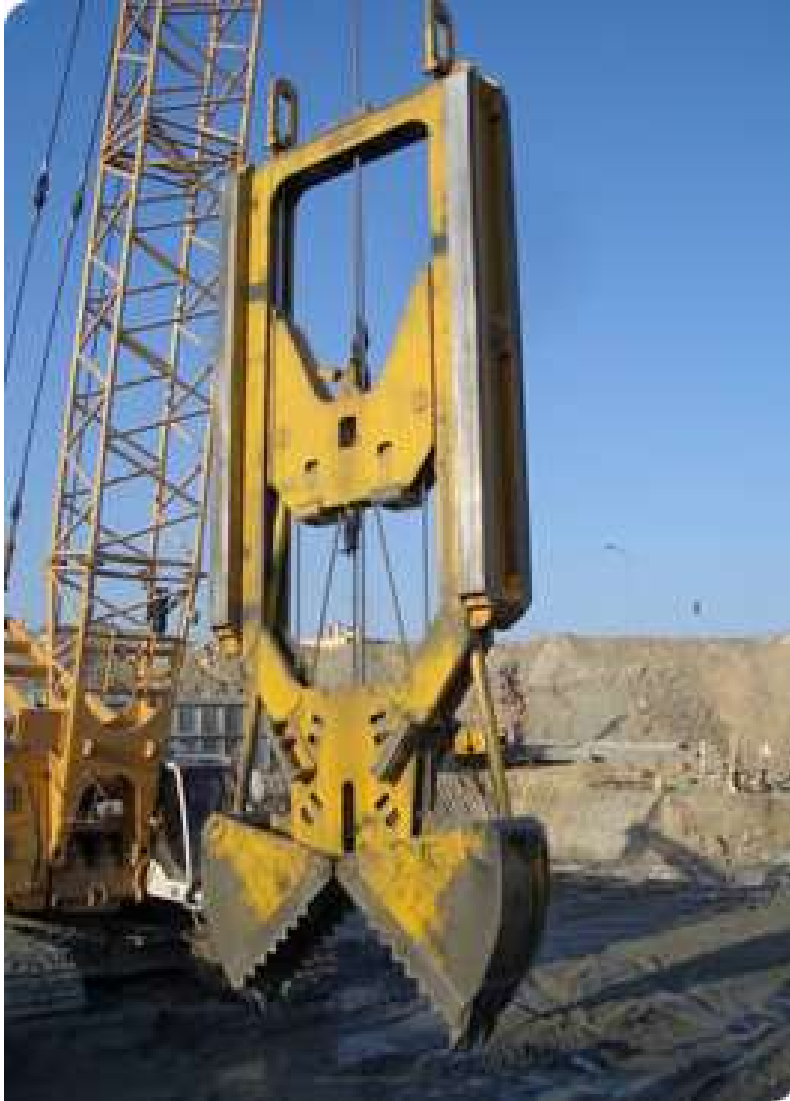
Slika 3.1 Mehanička grabilica CMX [2]
