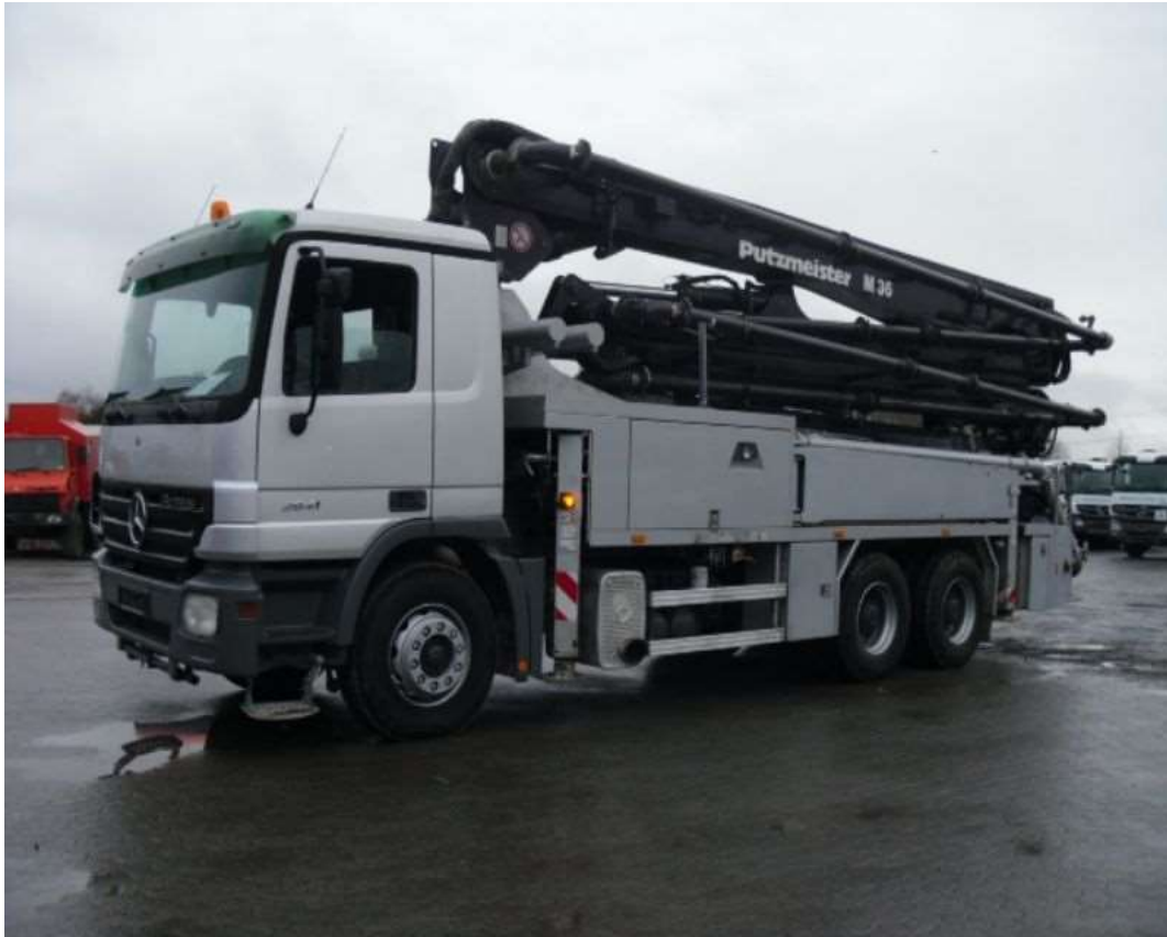
Slika 3.10 Pumpa za beton Mercedes-Benz 2641 Putzmeister 36m [4]
