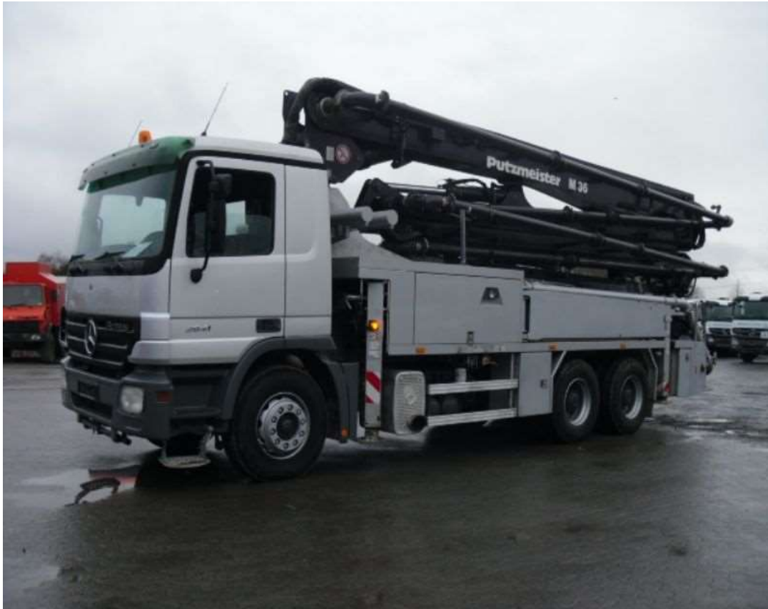
Slika 3.15 Pumpa za beton Mercedes-Benz 2641 Putzmeister 36m [4]
