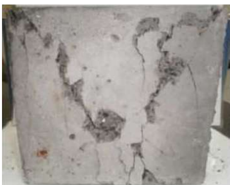
Slika 5.9: Mješavina 1; vertikalni lom[17]
