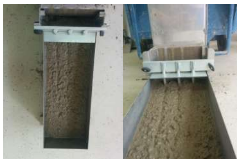
Slika 7.27: Ispitivanje L-posudom – mješavina L5
