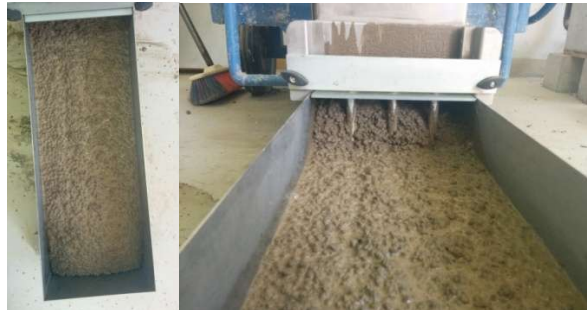
Slika 7.24: Ispitivanje L-posudom – mješavina L2
