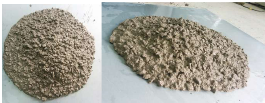
Slika 7.6: Rasprostiranje slijeganjem mješavine L4
