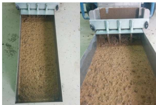
Slika 7.23: Ispitivanje L-posudom – mješavina L1
