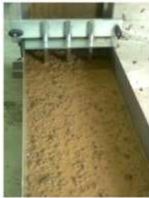
Fig. 5 L-box: SCLC1 - bleeding
