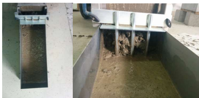
Slika 7.25: Ispitivanje L-posudom – mješavina L3
