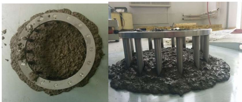
Slika 7.19: Ispitivanje J-prstenom - mješavina L5
