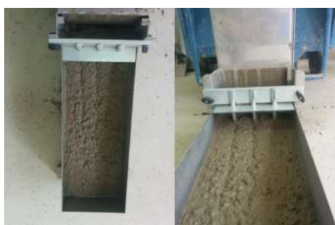
Slika 7.27: Ispitivanje L-posudom – mješavina L5
