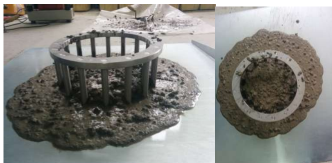
Slika 7.17: Ispitivanje J-prstenom - mješavina L3
