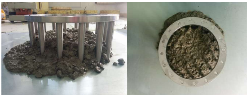
Slika 7.18: Ispitivanje J-prstenom - mješavina L4
