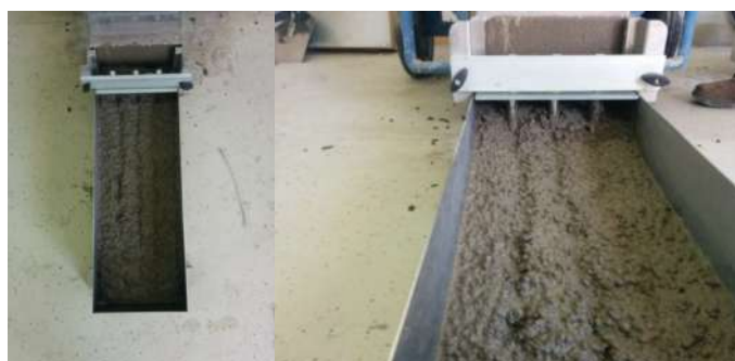
Slika 7.28: Ispitivanje L-posudom – mješavina L6
