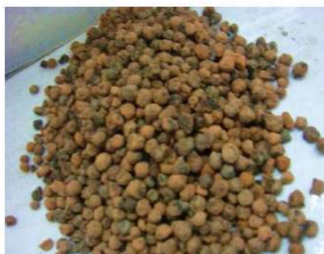
Slika 5.6: a) granulometrijski sastav zaprimljenog agregata (lijevo); b) prikaz laganog agregata od letećeg pepela (desno) [17]
