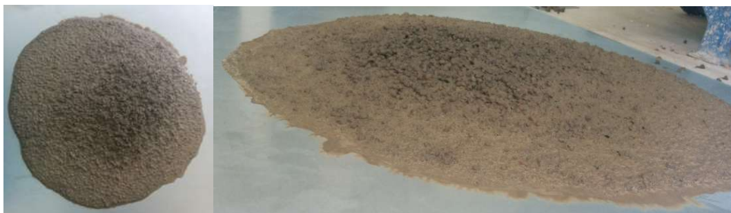
Slika 7.4: Rasprostiranje slijeganjem mješavine L2
