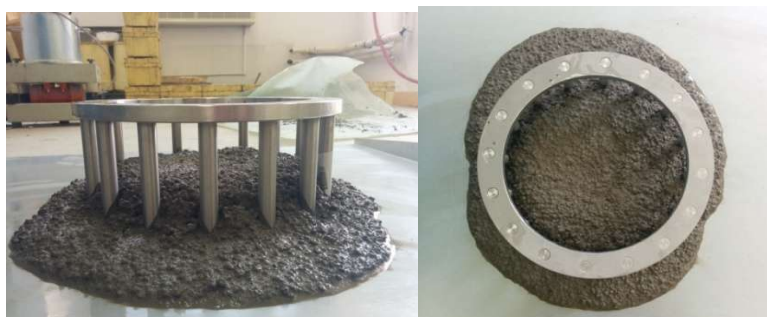
Slika 7.20: Ispitivanje J-prstenom - mješavina L6
