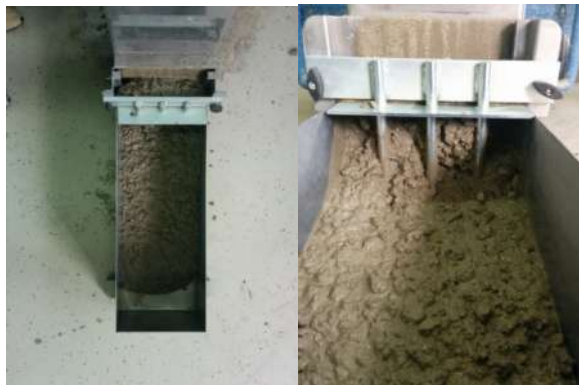
Slika 7.26: Ispitivanje L-posudom – mješavina L4
