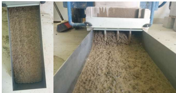
Slika 7.24: Ispitivanje L-posudom – mješavina L2
