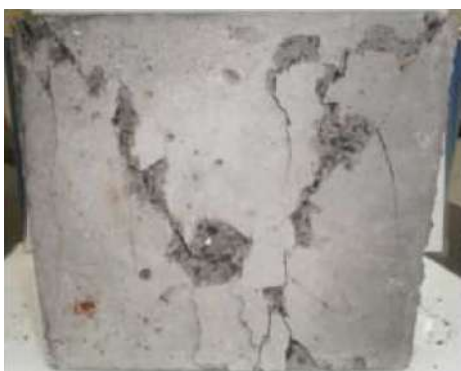
Slika 5.9: Mješavina 1; vertikalni lom[17]
