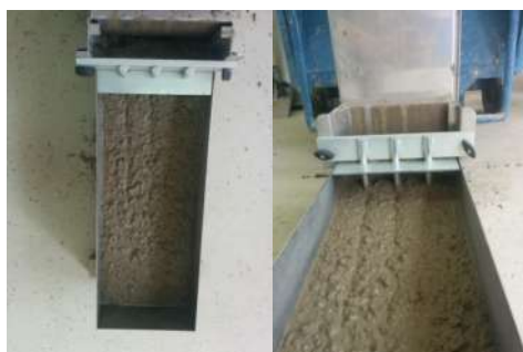
Slika 7.27: Ispitivanje L-posudom – mješavina L5
