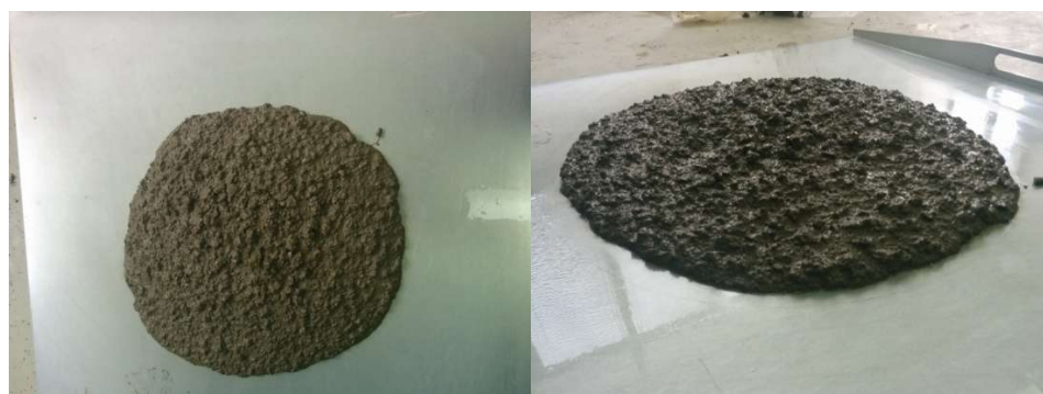
Slika 7.7: Rasprostiranje slijeganjem mješavine L5
