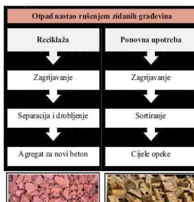
Slika 4.1: Zatvoreni ciklus recikliranja i ponovne upotrebe građevinskog otpada[11]
