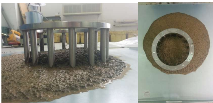
Slika 7.15: Ispitivanje J-prstenom - mješavina L1
