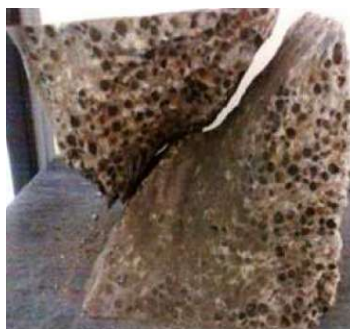
Slika 5.11: Mješavina 2; vertikalni lom i smicanje[17]
