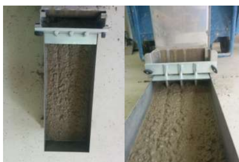
Slika 7.27: Ispitivanje L-posudom – mješavina L5
