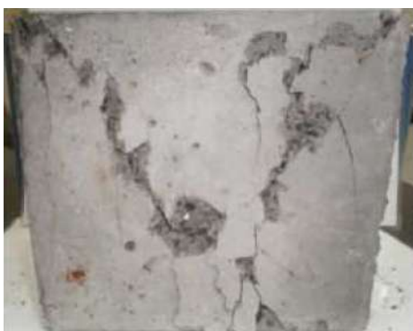
Slika 5.9: Mješavina 1; vertikalni lom[17]
