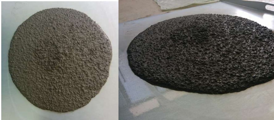
Slika 7.8: Rasprostiranje slijeganjem mješavine L6
