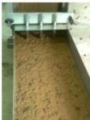
Fig. 5 L-box: SCLC1 - bleeding
