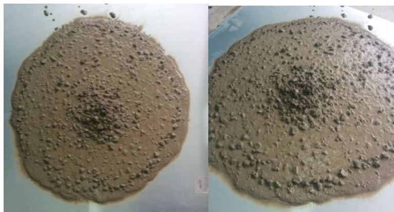
Slika 7.5: Rasprostiranje slijeganjem mješavine L3
