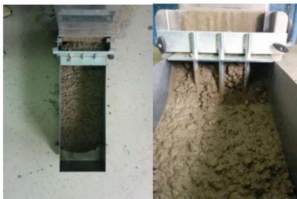
Slika 7.26: Ispitivanje L-posudom – mješavina L4
