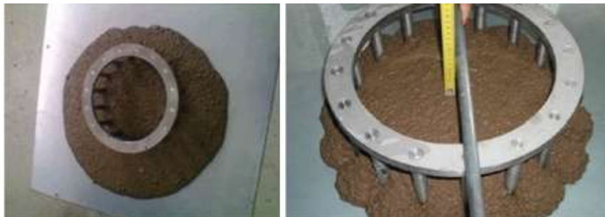
Slika 5.14: J-prsten: a) Mješavina SCLC1- odvajanje vode na rubovima (slika lijevo); b) Mješavina SCLC5- ljepljiva mješavina (slika desno)[18]
