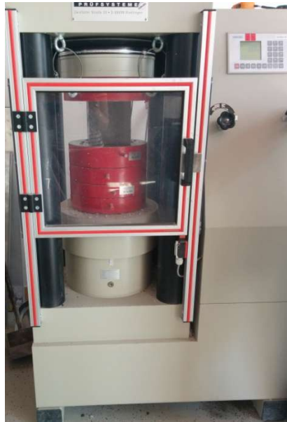
Slika 8.1: Preša za ispitivanje tlačne čvrstoće betona
