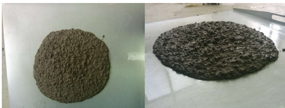
Slika 7.7: Rasprostiranje slijeganjem mješavine L5
