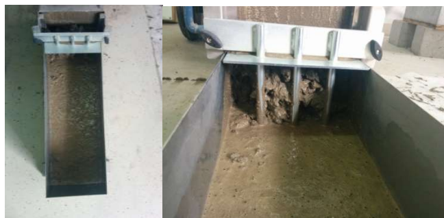
Slika 7.25: Ispitivanje L-posudom – mješavina L3
