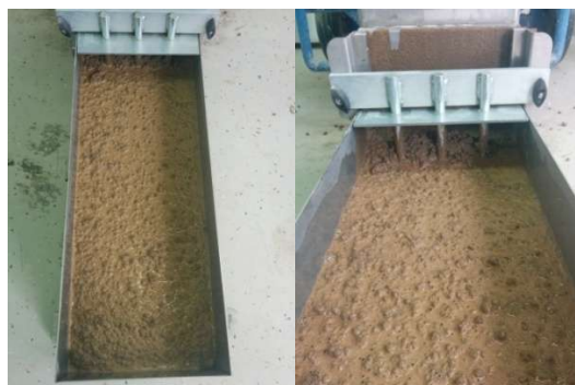
Slika 7.23: Ispitivanje L-posudom – mješavina L1
