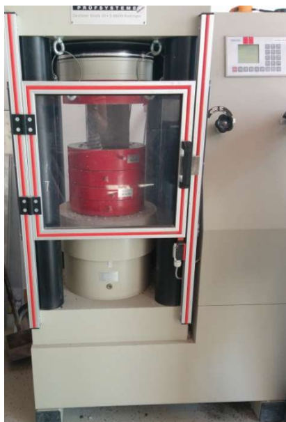
Slika 8.1: Preša za ispitivanje tlačne čvrstoće betona
