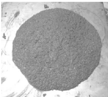
Slika 5.7: Mješavina 1; rasprostiranje slijeganjem[17]
