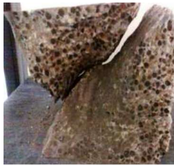
Slika 5.11: Mješavina 2; vertikalni lom i smicanje[17]
