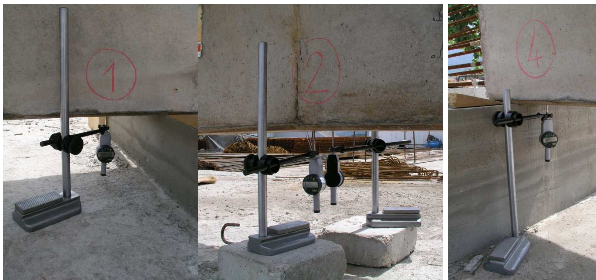
Slika 3.7. Mikrourice i mjerna mjesta
