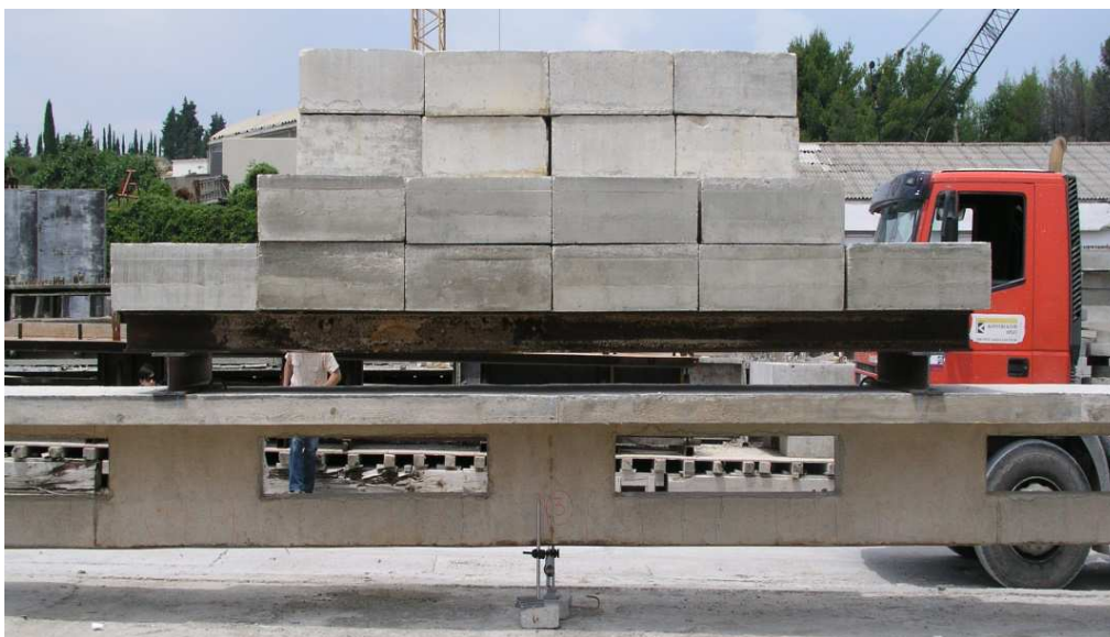
Slika 3.6. IV faza opterećenja (18 betonskih blokova)
