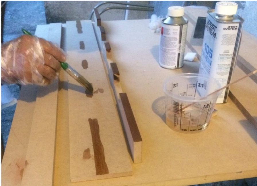
Slika 8.4. Međusobno lijepljenje elemenata potrebnih za sastavljanje modela
