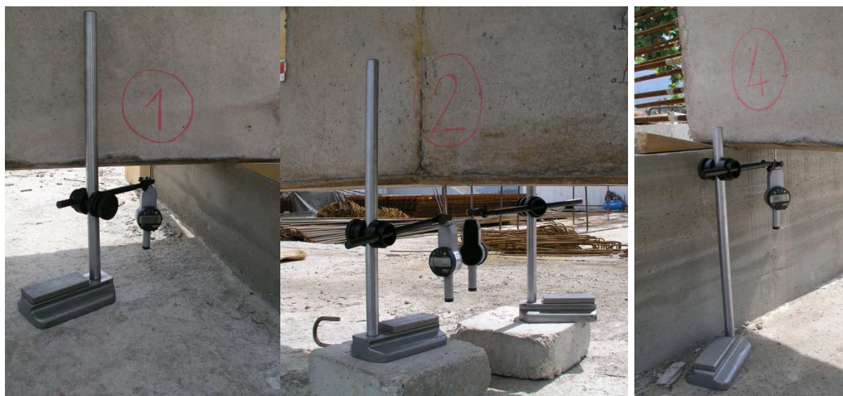
Slika 3.7. Mikrourice i mjerna mjesta
