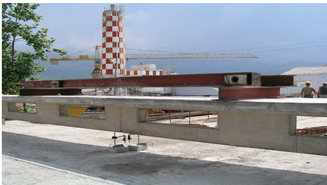
Slika 3.3. Prva faza opterećenja (okvir)
