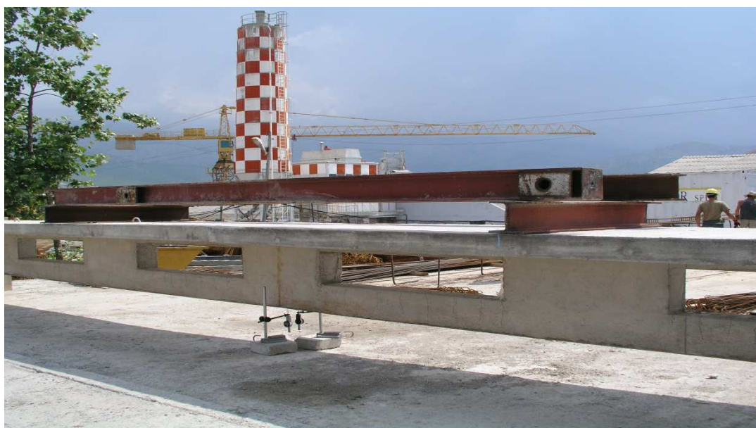
Slika 3.3. Prva faza opterećenja (okvir)
