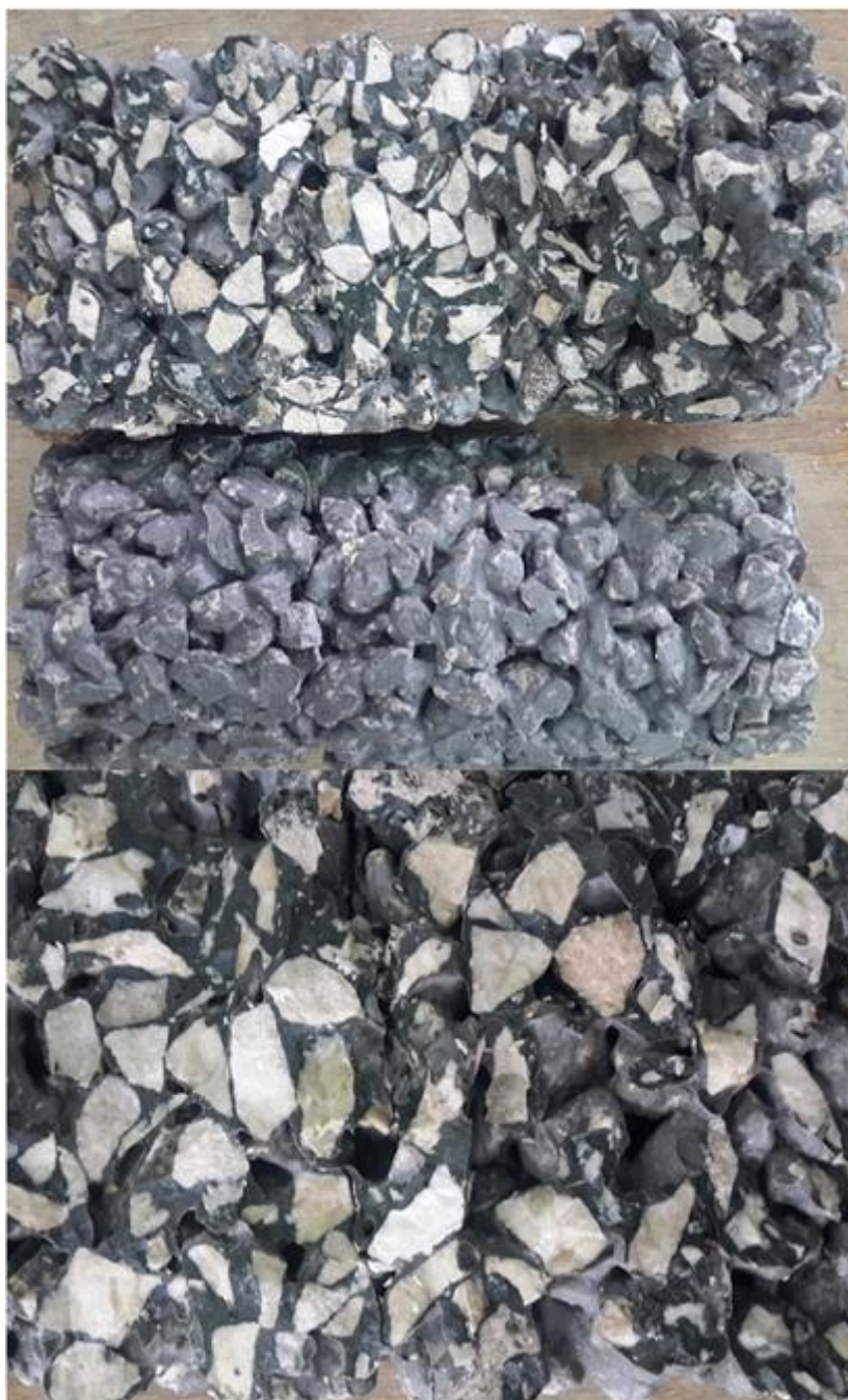
Slika 5.14 Raspored i količina šupljina mješavine B 6
