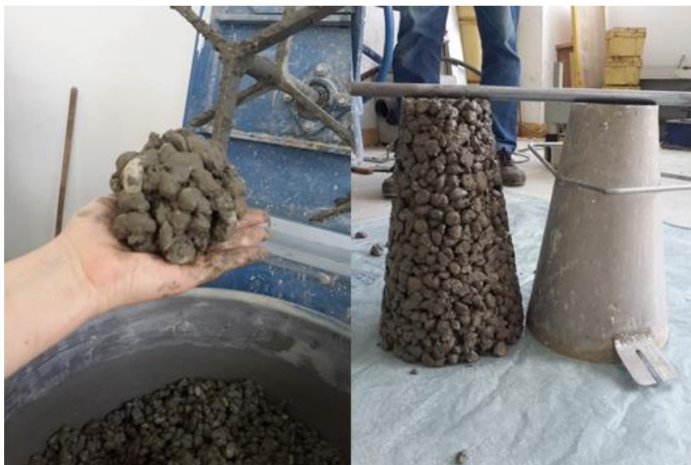
Slika 5.3 Ispitivanje konzistencije mješavine B 3
