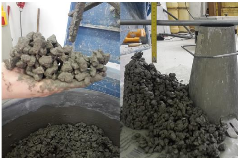
Slika 5.7 Ispitivanje konzistencije mješavine B 8
