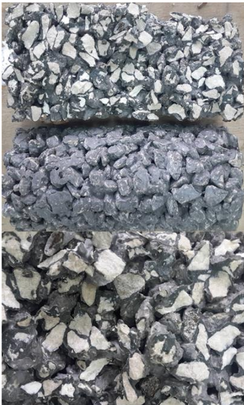
Slika 5.13 Raspored i količina šupljina mješavine B 5
