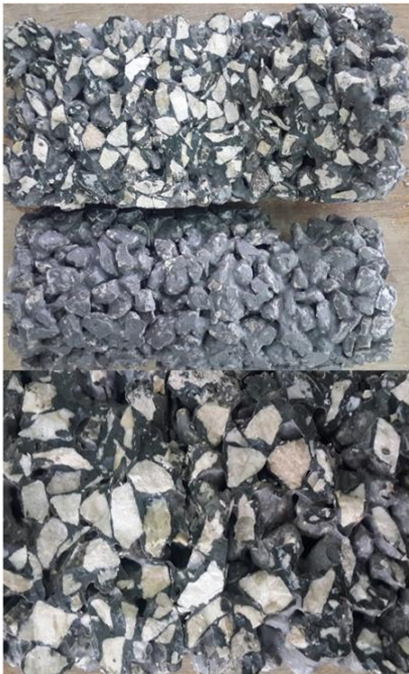
Slika 5.14 Raspored i količina šupljina mješavine B 6
