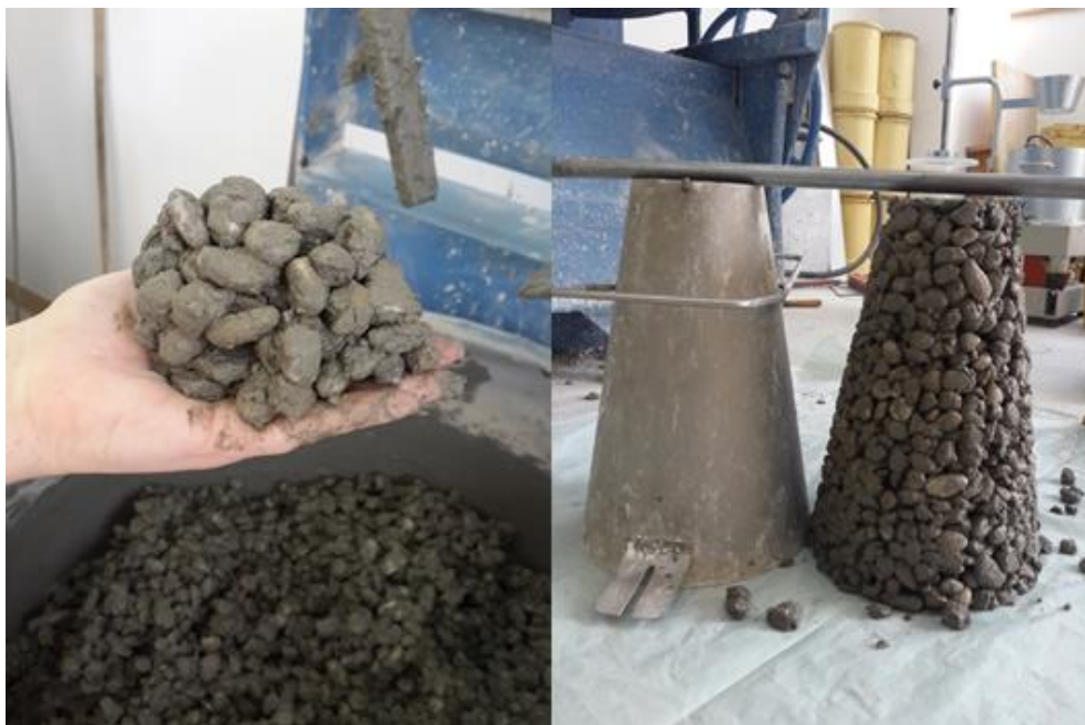
Slika 5.2 Ispitivanje konzistencije mješavine B 2
