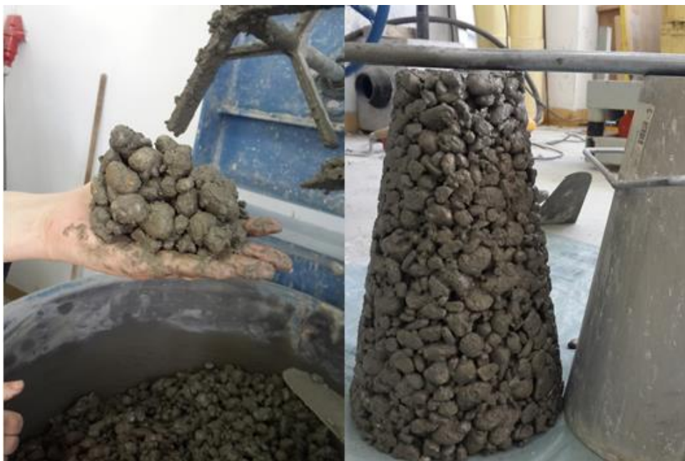
Slika 5.4 Ispitivanje konzistencije mješavine B 4
