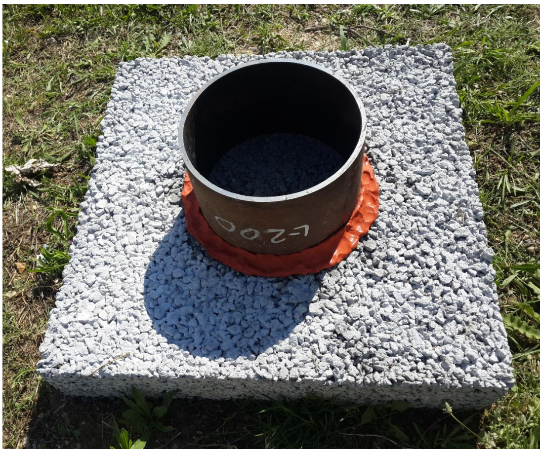
Slika 4.30 Brtvljeni, infiltracijski prsten postavljen na porozno – betonsku ploču
