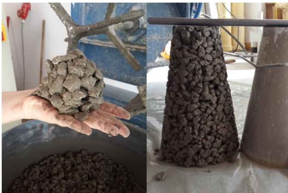
Slika 5.5 Ispitivanje konzistencije mješavina B 5 i B 6
