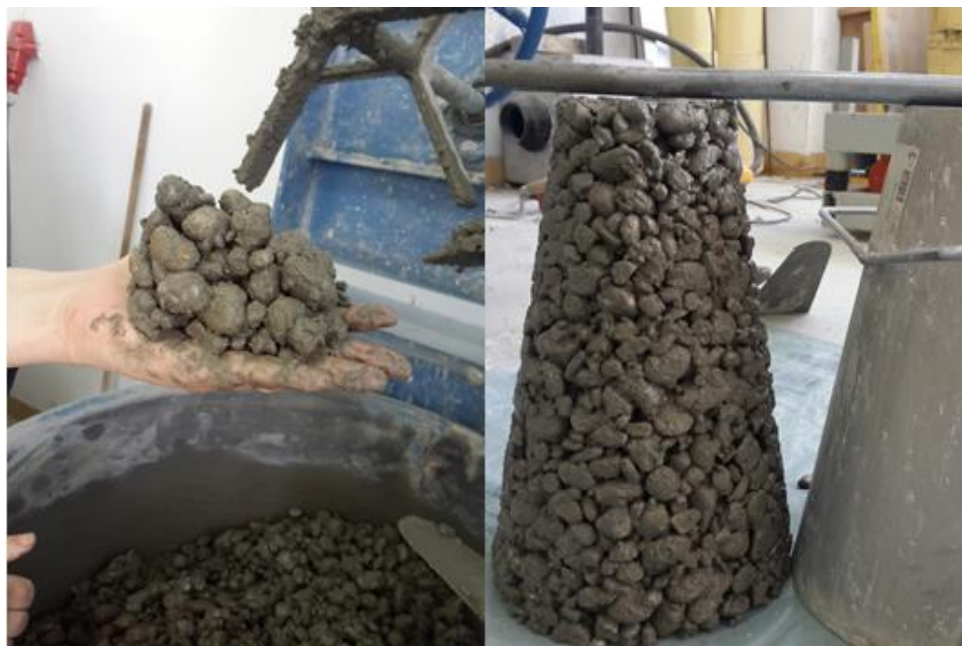
Slika 5.4 Ispitivanje konzistencije mješavine B 4
