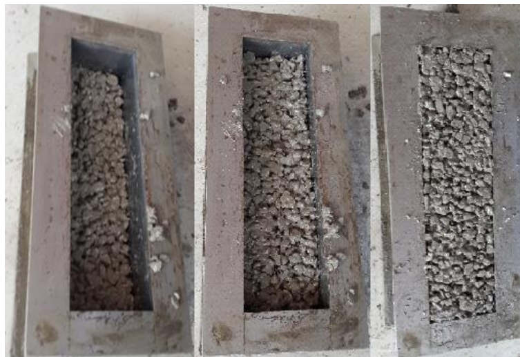
Slika 4.27 Slojevi pri ugradnji betona u kalupe oblika prizme
