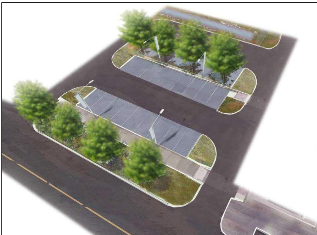
Slika 2.3 Parkirališna mjesta od poroznog betona [10]
