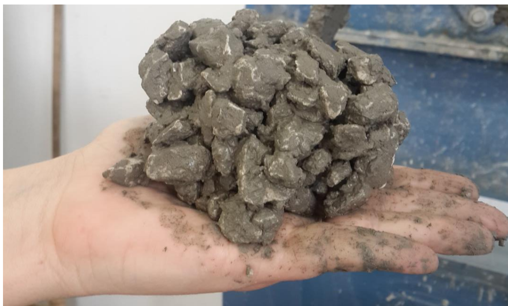
Slika 4.15 Ispitivanje konzistencije metodom oblikovanja kuglice
