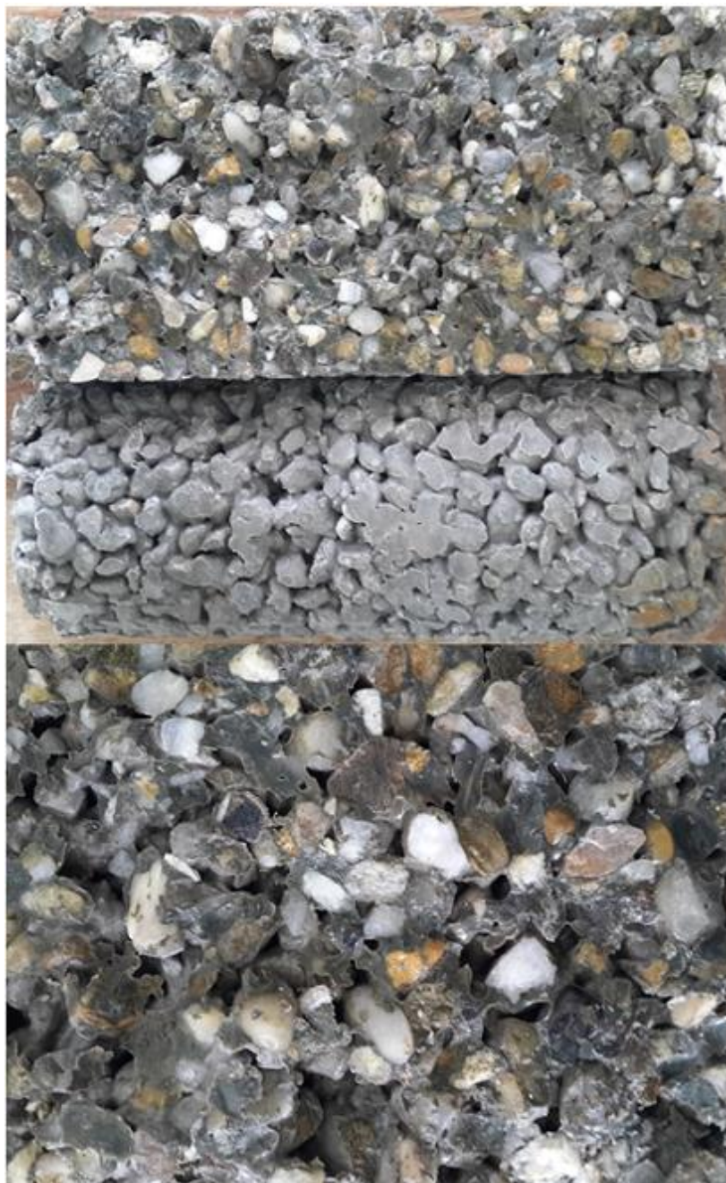
Slika 5.9 Raspored i količina šupljina mješavine B 1
