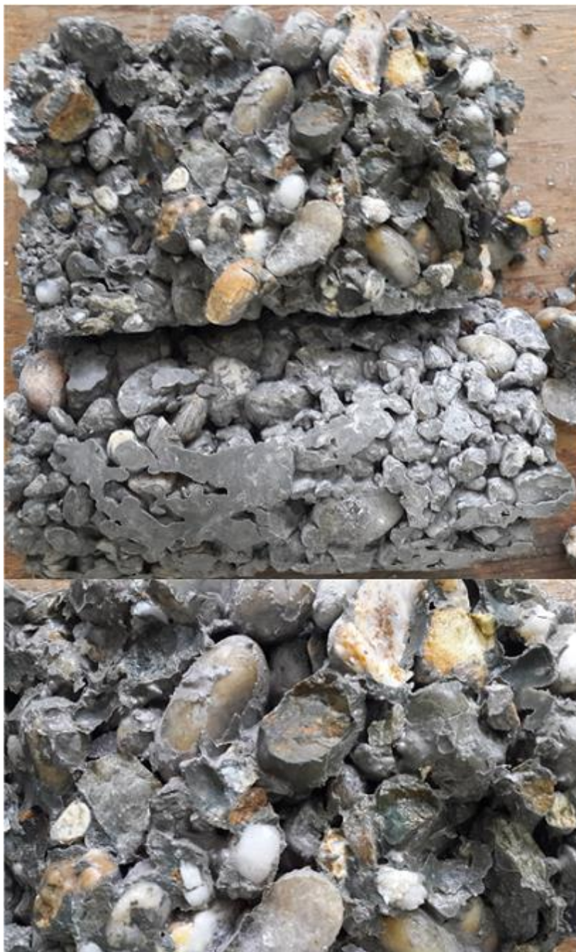
Slika 5.12 Raspored i količina šupljina mješavine B 4
