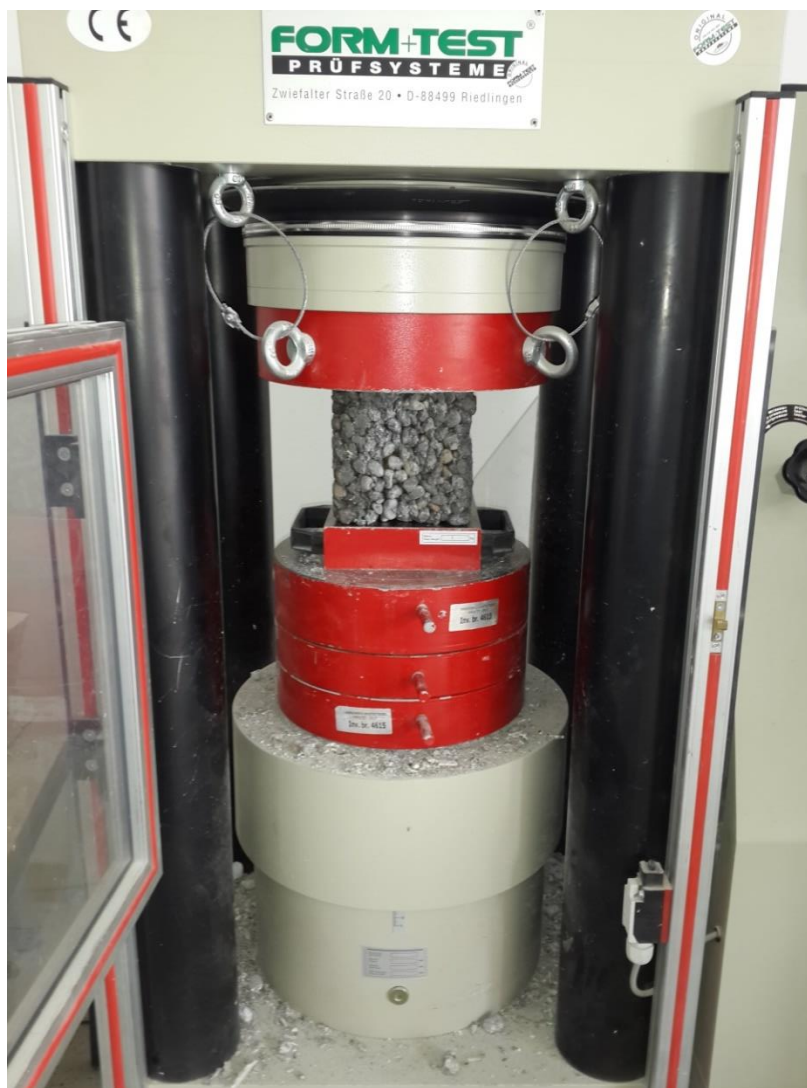
Slika 4.19 Hidraulička preša za ispitivanje tlačne čvrstoće
