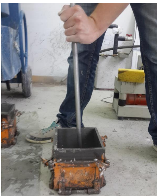
Slika 4.8 Ugrađivanje uzoraka čeličnom šipkom
