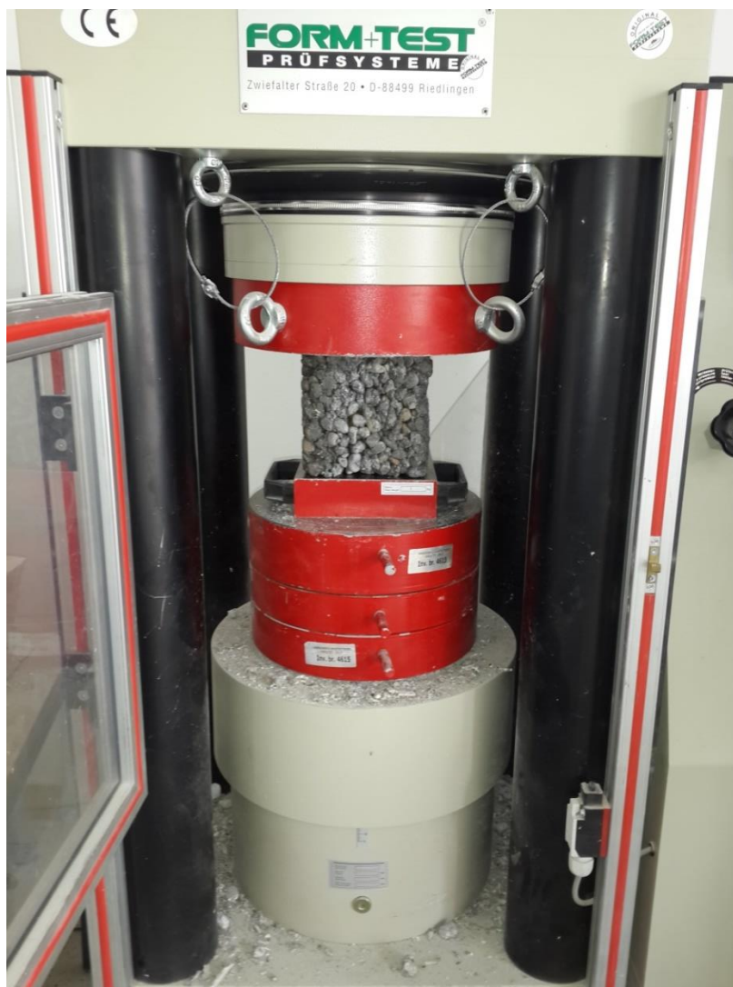
Slika 4.19 Hidraulička preša za ispitivanje tlačne čvrstoće
