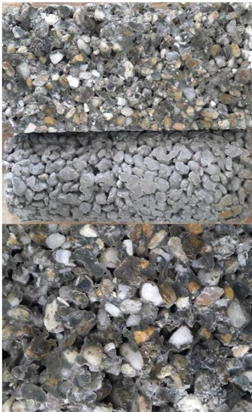
Slika 5.9 Raspored i količina šupljina mješavine B 1
