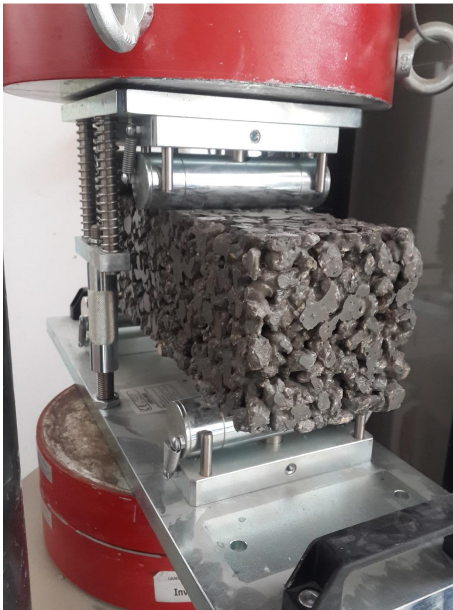
Slika 4.28 Opterećenje uzorka smještenog između valjaka
