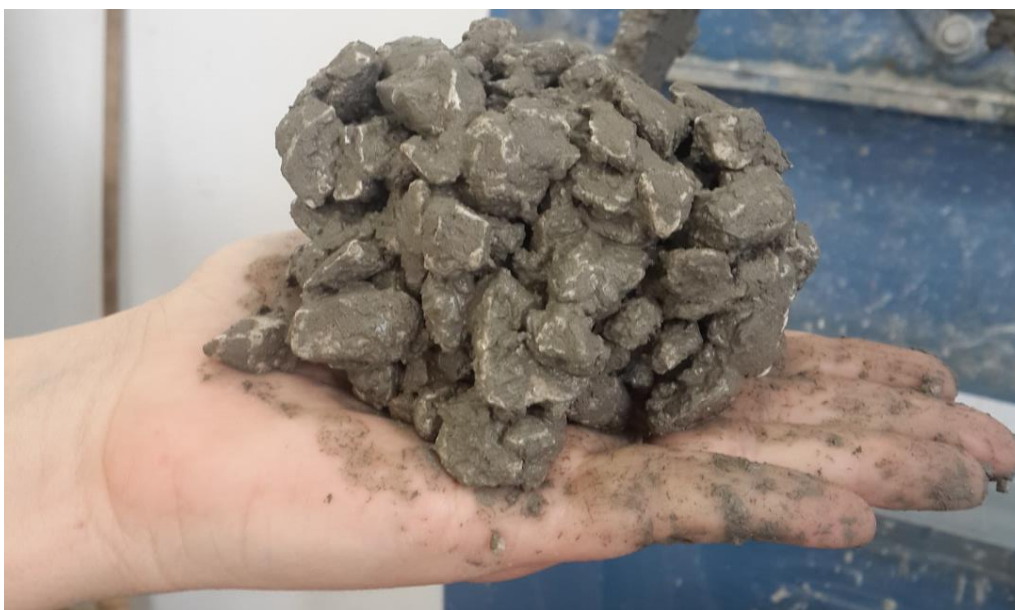
Slika 4.15 Ispitivanje konzistencije metodom oblikovanja kuglice
