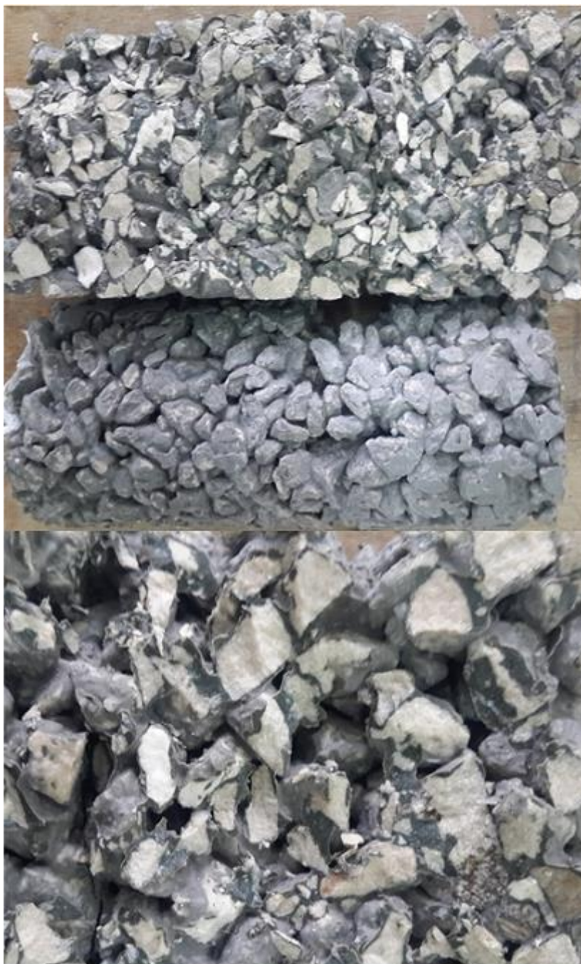
Slika 5.16 Raspored i količina šupljina mješavine B 8
