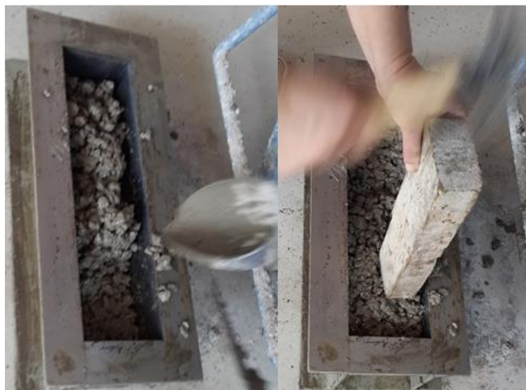
Slika 4.26 Ugradnja i zbijanje betona drvenom letvom i čekićem u kalupe
