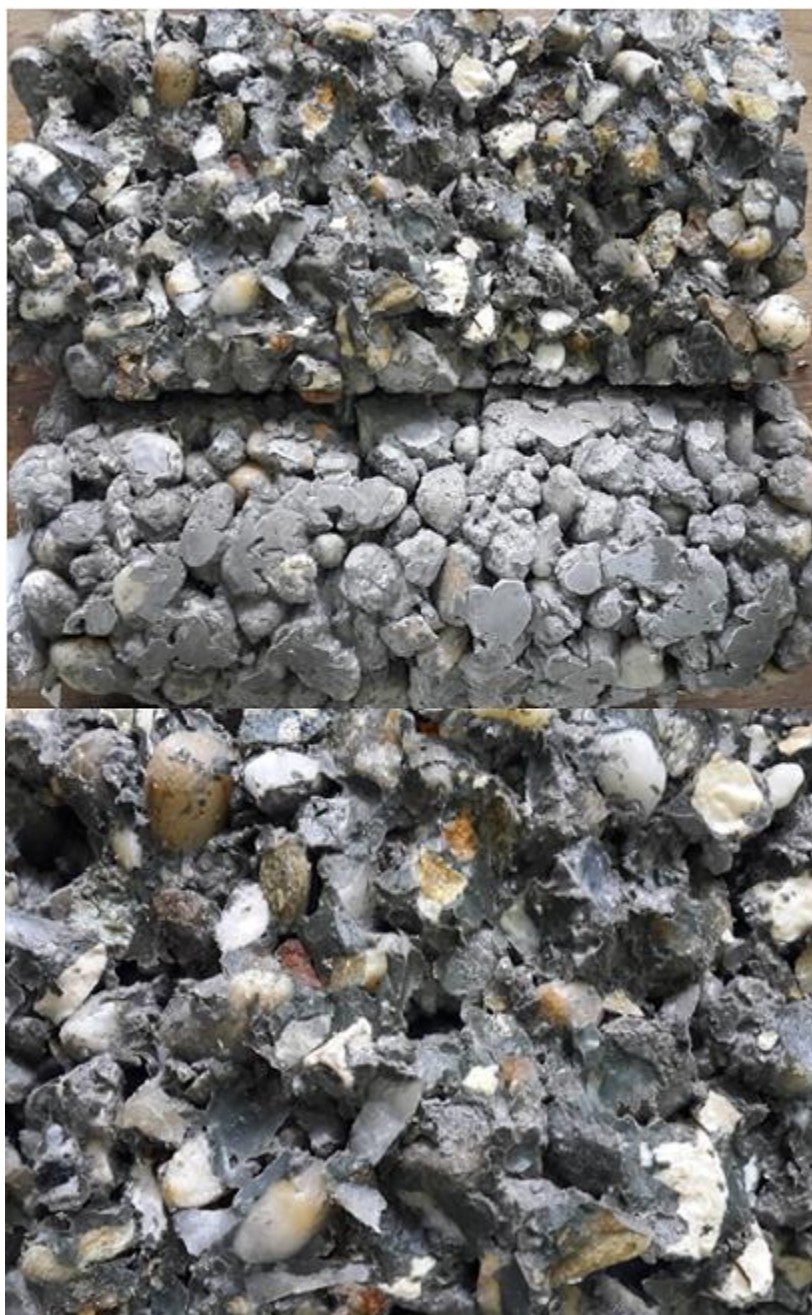
Slika 5.11 Raspored i količina šupljina mješavine B 3
