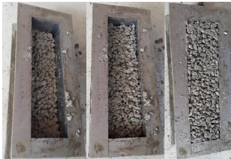
Slika 4.27 Slojevi pri ugradnji betona u kalupe oblika prizme
