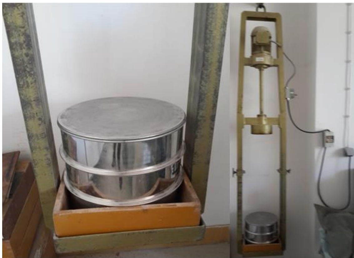
Slika 4.5 Uređaj za strojno prosijavanje agregata
