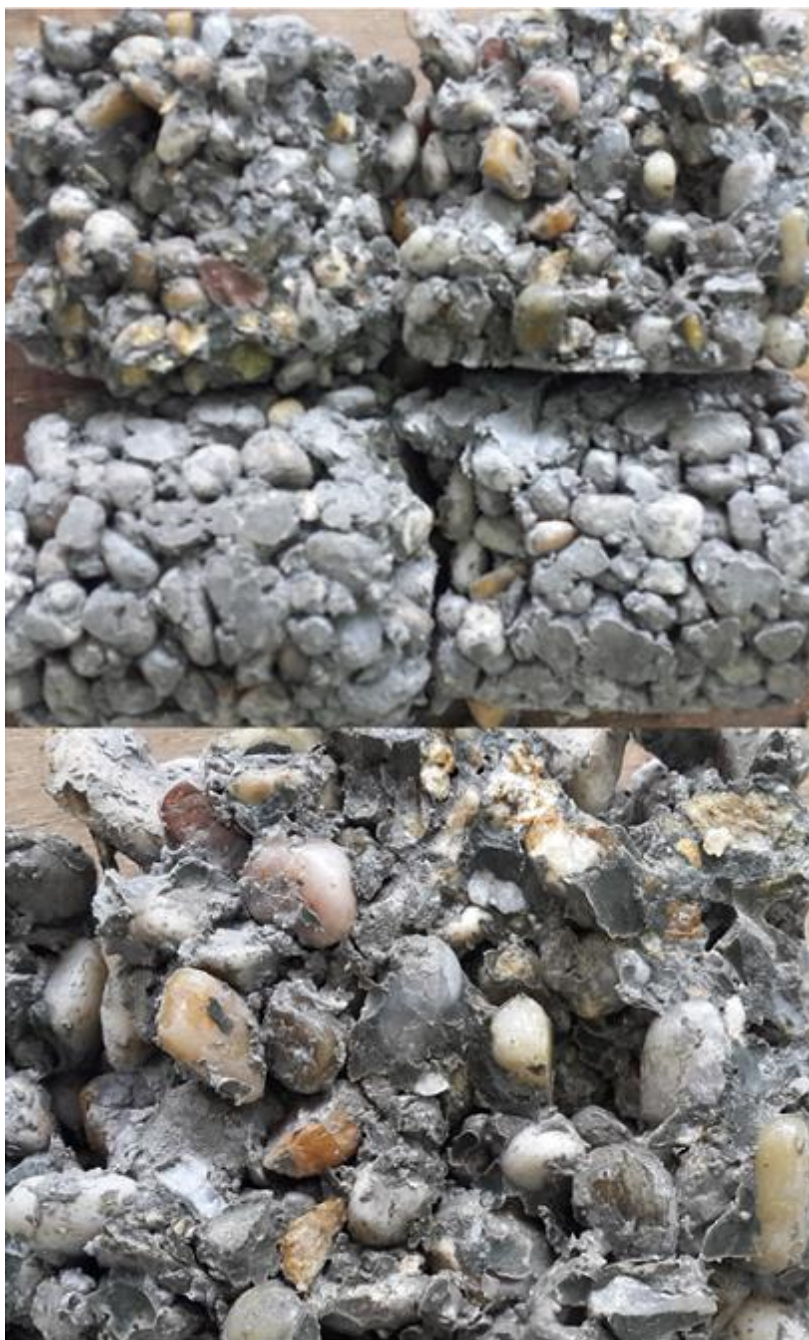
Slika 5.10 Raspored i količina šupljina mješavine B 2
