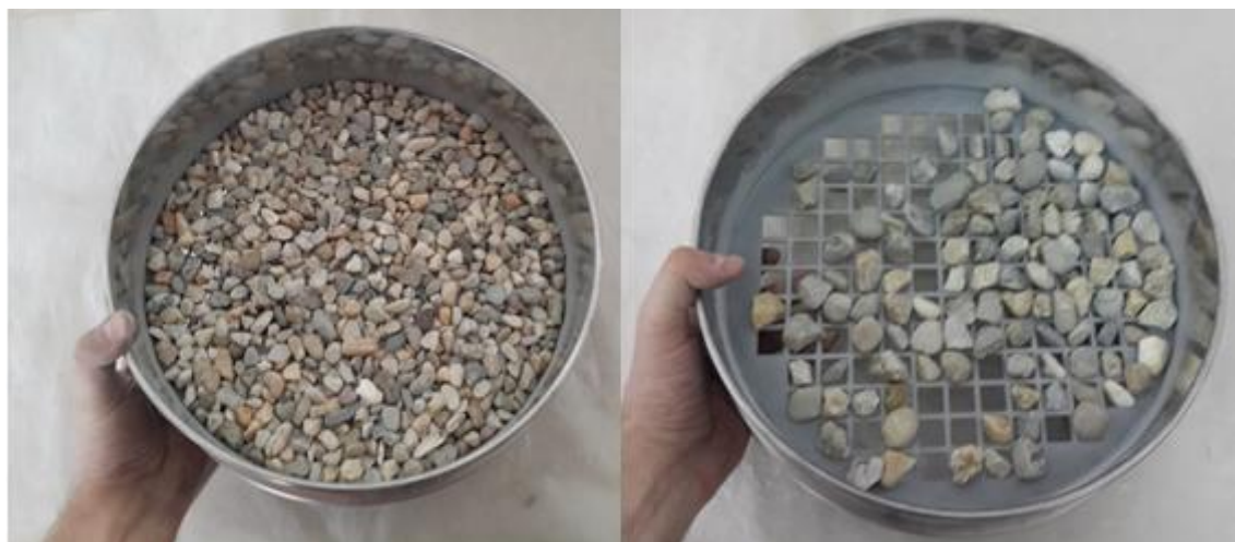
Slika 4.6 Ručno prosijavanje agregata na sitima kvadratnih otvora
