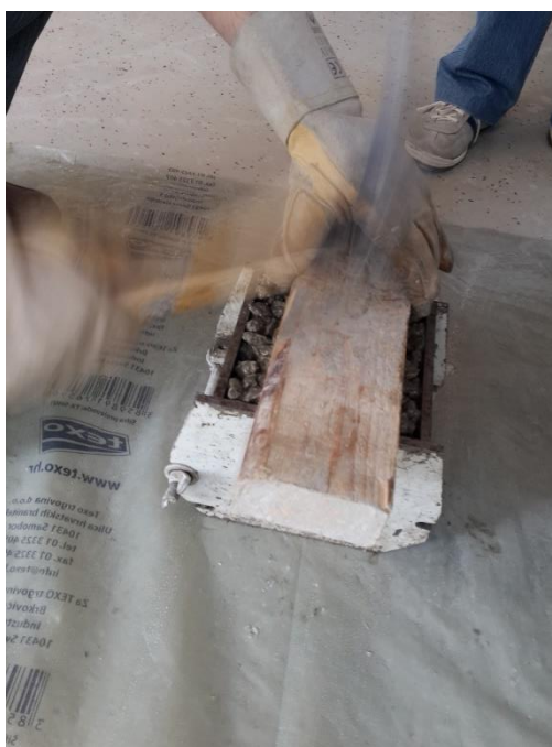
Slika 4.10 Zbijanje zadnjeg sloja betona drvenom letvom
