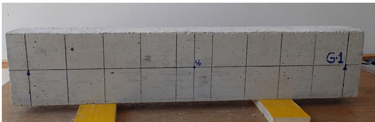
Fotografija 4.1. Greda G1 označena za ispitivanje
