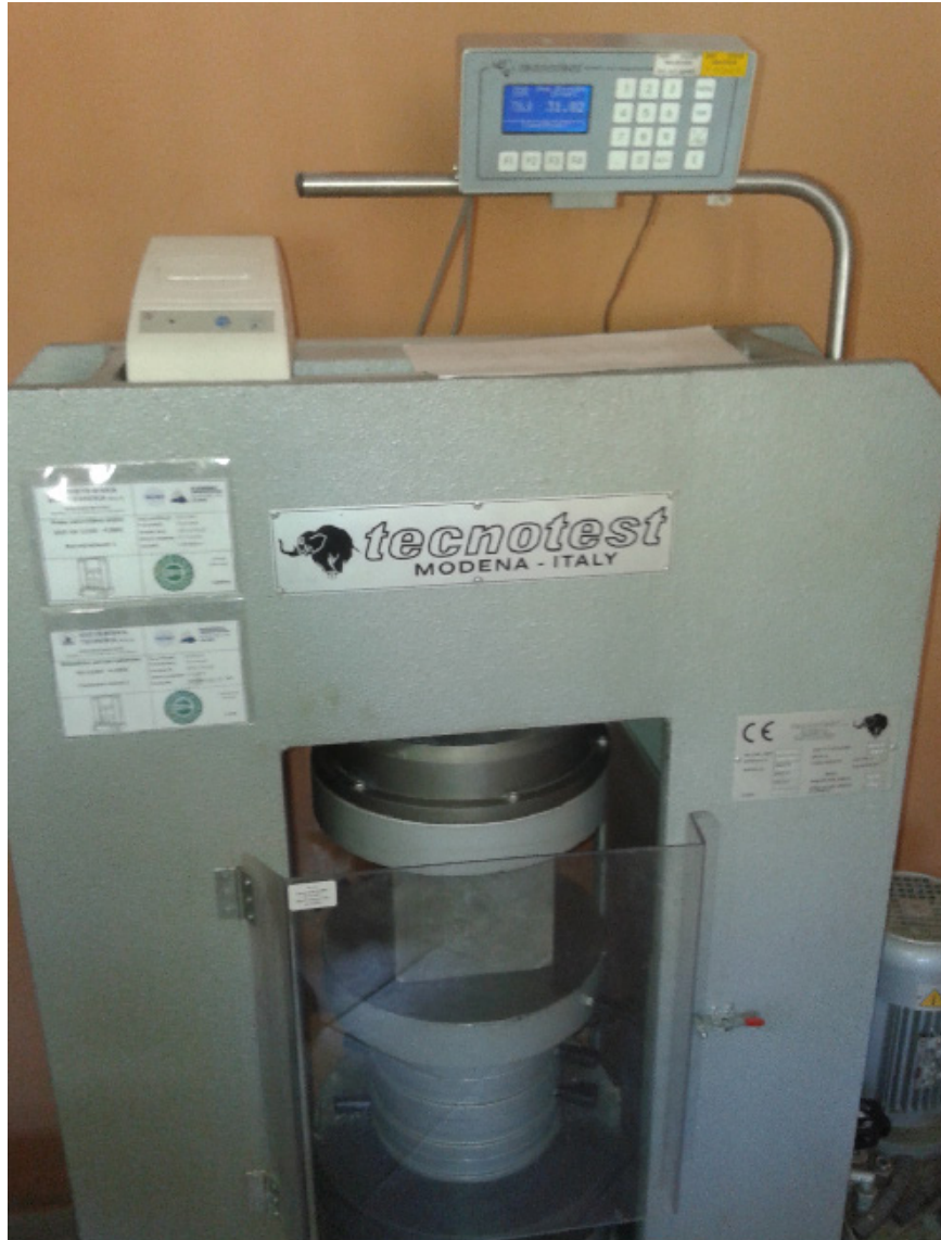
Fotografija 2.7. Uzorci U1 prilikom ispitivanja tlačne čvrstoće
