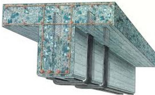
Crtež 2.4. Ojačanje karbonskim vlaknima
