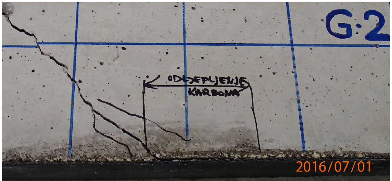
Fotografija 4.16. Grede G2 nakon sloma, prikaz odljepljenja karbonske trake
