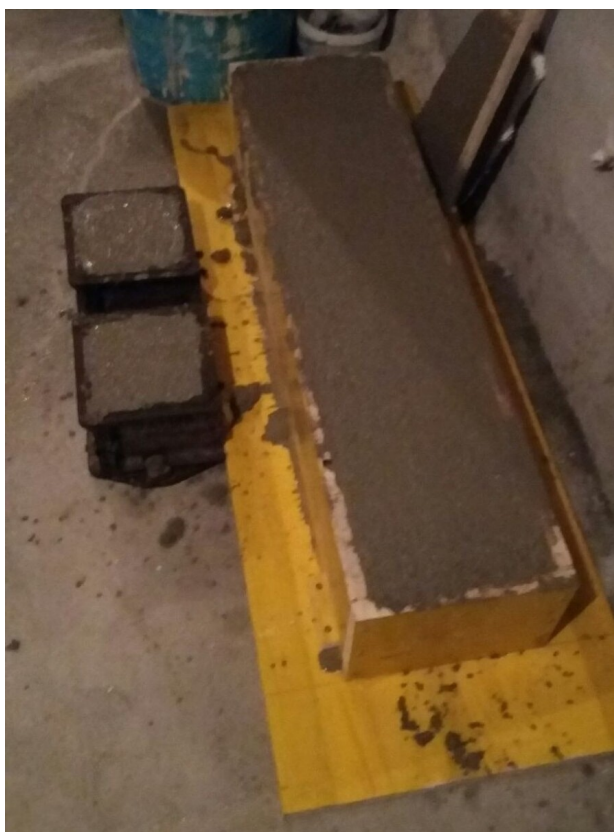
Fotografija 2.5. Grede i uzorci za ispitivanje nedugo nakon izvođenja
