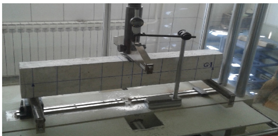
Fotografija 4.6 Rubni uvjeti oslanjanja grede i postavljena mikroura
