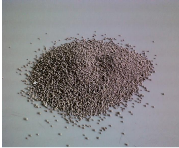
Slika 4.5. Granulirano staklo Liaver
