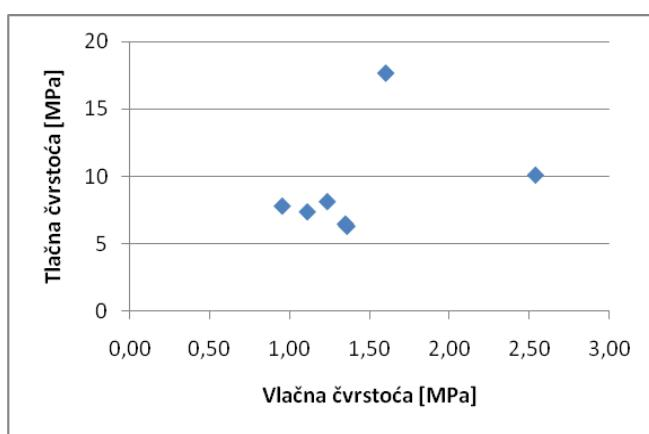
**Slika 4.40.** Veza između tlačne i vlačne čvrstoće
