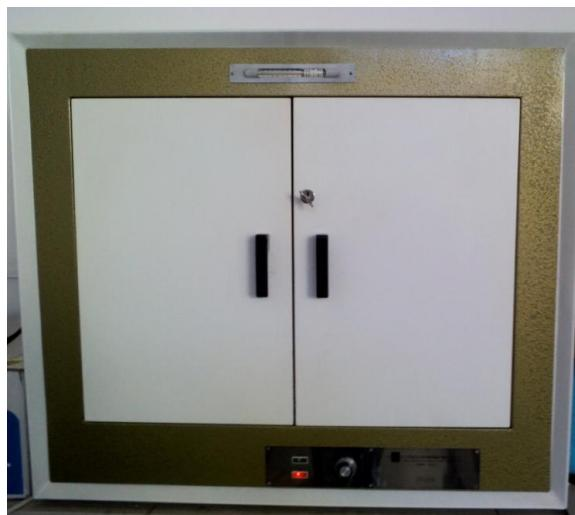
Slika 4.10. Uređaj za sušenje uzorka
