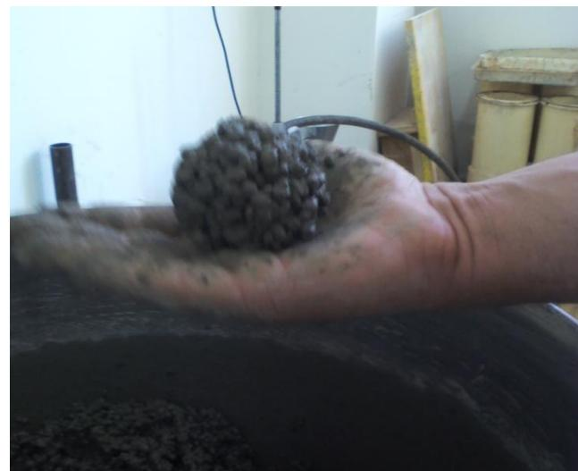
**Slika 4.19.** Ispitivanje konzistencije mješavine K<sub>5</sub>
