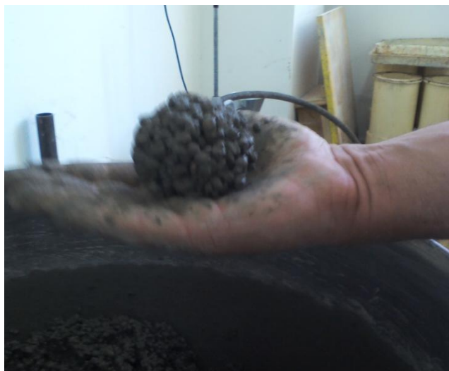
Slika 4.19. Ispitivanje konzistencije mješavine K 5
