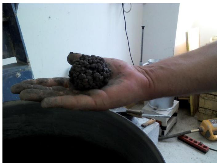
**Slika 4.21.** Ispitivanje konzistencije mješavine K<sub>7</sub>
