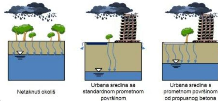
**Slika 1.2.** Utjecaj propusnoga betona na razinu podzemnih voda [3]
