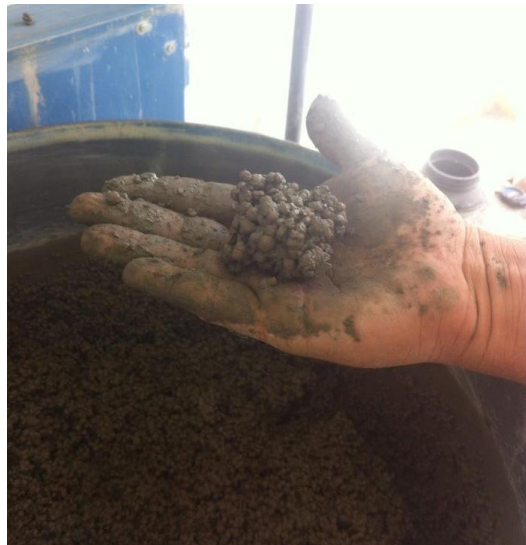
Slika 4.15. Ispitivanje konzistencije mješavine K_1
