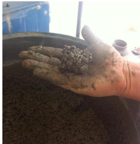
**Slika 4.15.** Ispitivanje konzistencije mješavine  $K_1$
