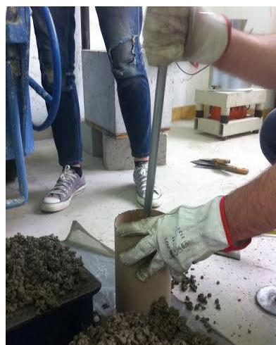
**Slika 4.8.** Ugrađivanje uzoraka u kalupe
