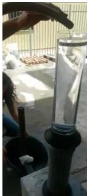
**Slika 4.12.** Ispitivanje propusnosti metodom stalne razine stupca vode
