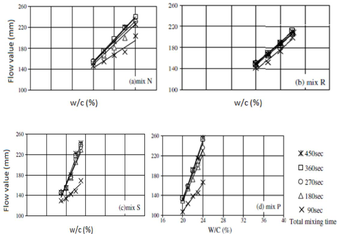
**Slika 3.2.** Grafovi ovisnosti razastiranja i vodocementnoga faktora[13]
