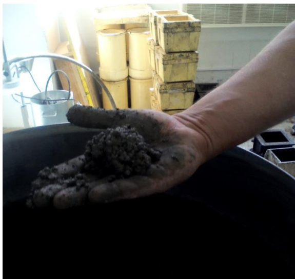
Slika 4.17. Ispitivanje konzistencije mješavine K 3
