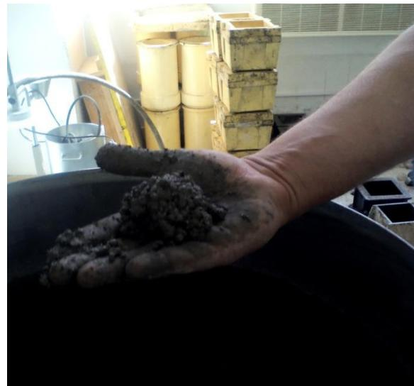
**Slika 4.17.** Ispitivanje konzistencije mješavine K<sub>3</sub>
