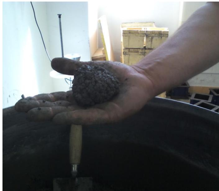
**Slika 4.20.** Ispitivanje konzistencije mješavine K<sub>6</sub>
