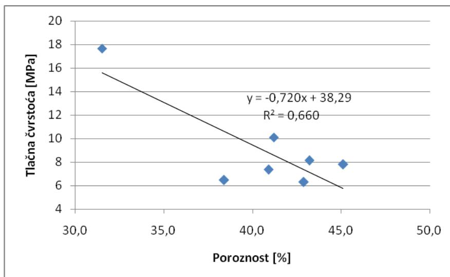
**Slika 4.37.** Veza između poroznosti i tlačne čvrstoće
