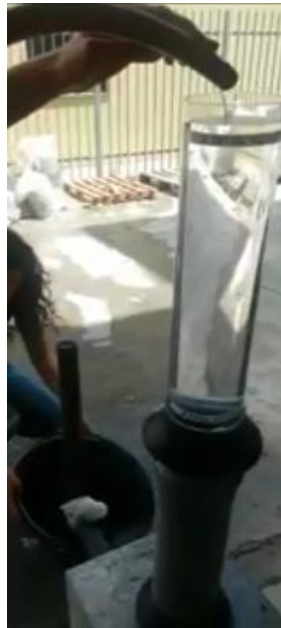
Slika 4.12. Ispitivanje propusnosti metodom stalne razine stupca vode
