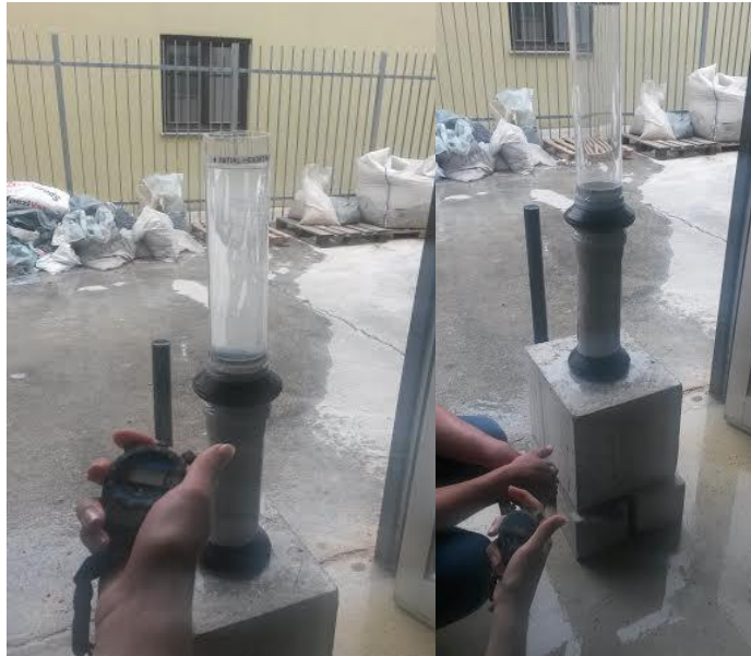
Slika 4.13. Mjerenje koeficijenta propusnosti metodom padajuće razine stupca vode
