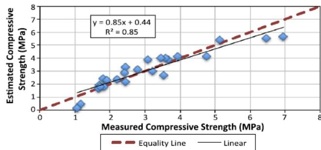
**Slika 3.18.** Odnos mjerene i procijenjene tlačne čvrstoće[16]
