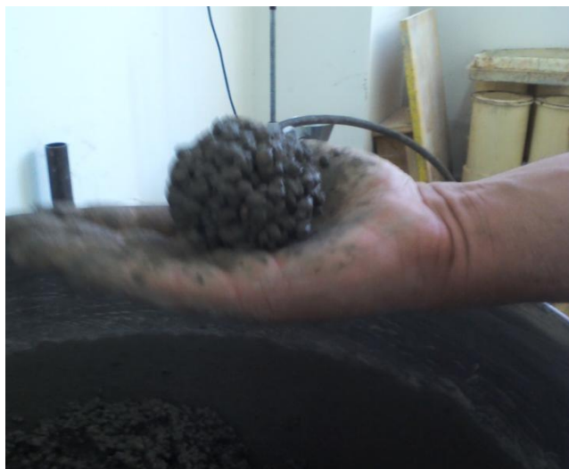
Slika 4.19. Ispitivanje konzistencije mješavine K 5
