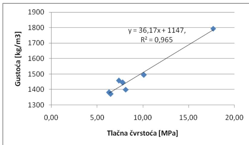
Slika 4.34. Veza između tlačne čvrstoće i gustoće
