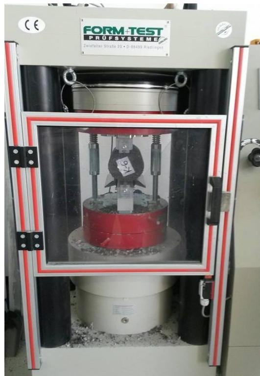
**Slika 4.14.** Preša za ispitivanje vlačne čvrstoće cijepanjem
