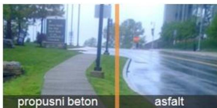
**Slika 1.3.** Usporedba vodopropusnosti površina od propusnoga betona i asfalta [3]
