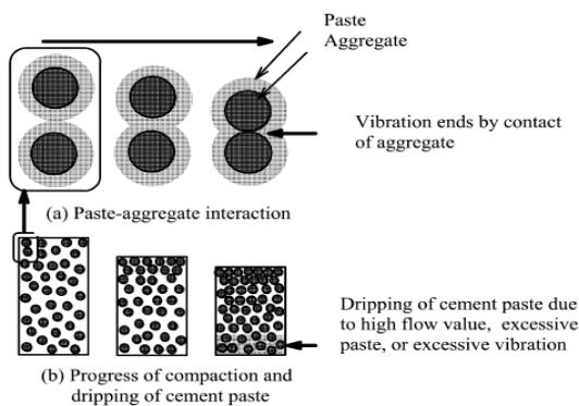
**Slika 3.6.** Proces zbijanja površinskom vibracijom[13]
