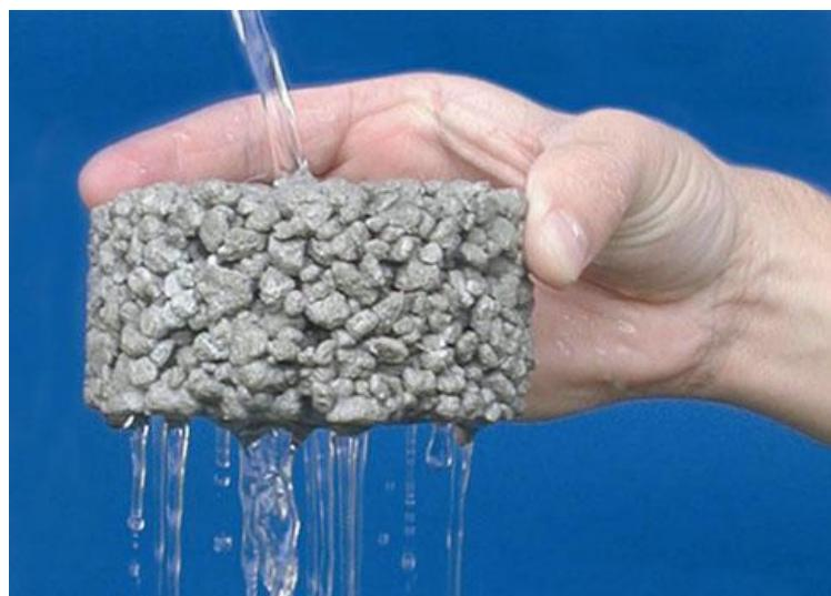
Slika 1.1. Porozni beton [2]
