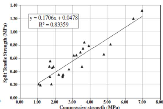
**Slika 3.14.** Veza između vlačne i tlačne čvrstoće[16]
