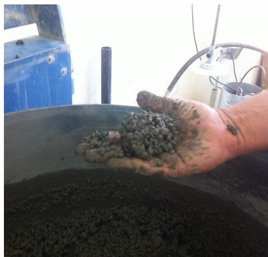
**Slika 4.16.** Ispitivanje konzistencije mješavine K<sub>2</sub>
