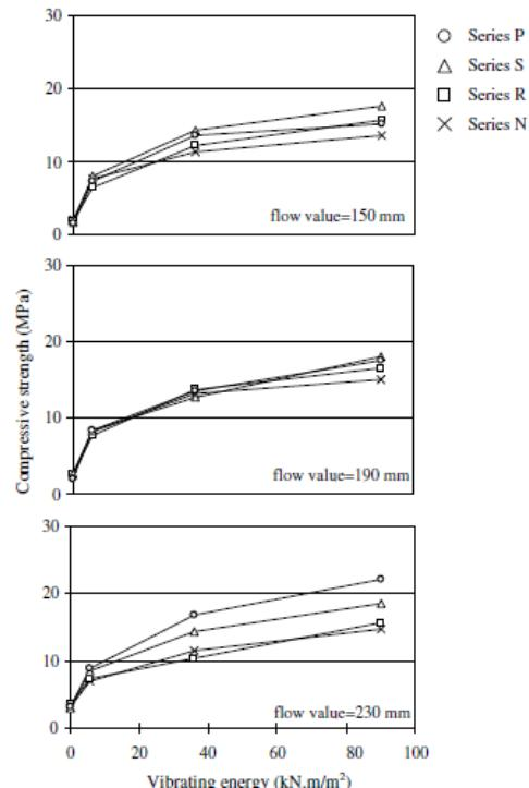
**Slika 3.5.** Veza između tlačne čvrstoće i energije vibriranja[13]
