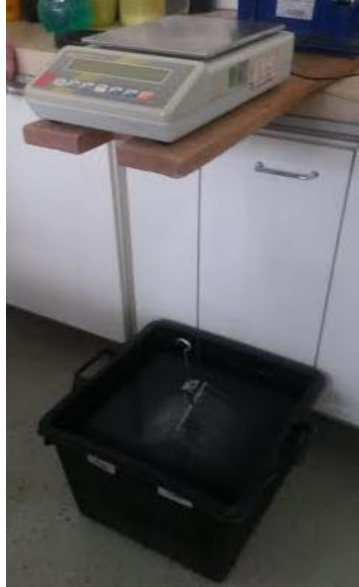
Slika 4.11. Vaganje uzoraka potopljenih u vodi
