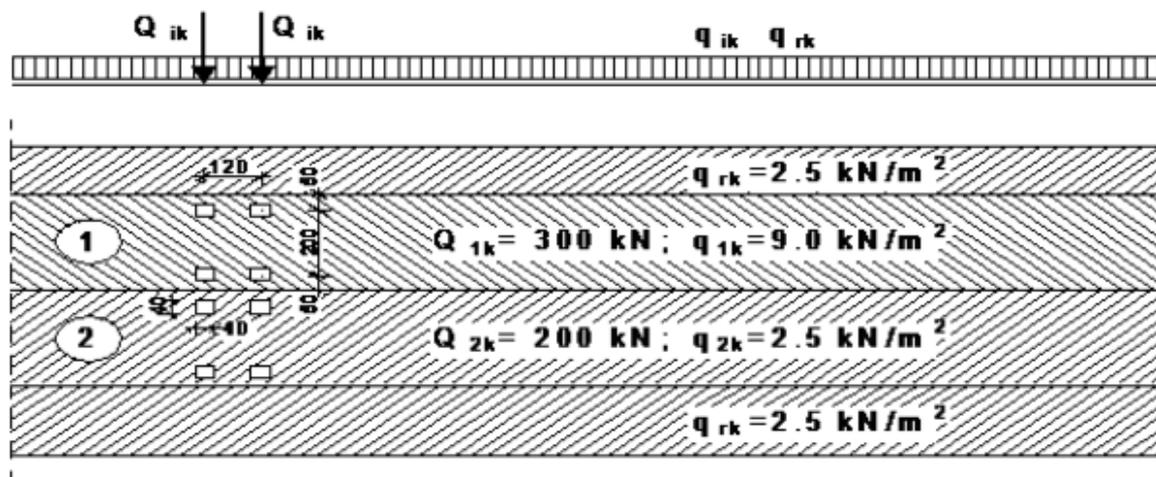
Slika 13 : Prikaz načina opterećivanja mosta pokretnim opterećenjem
