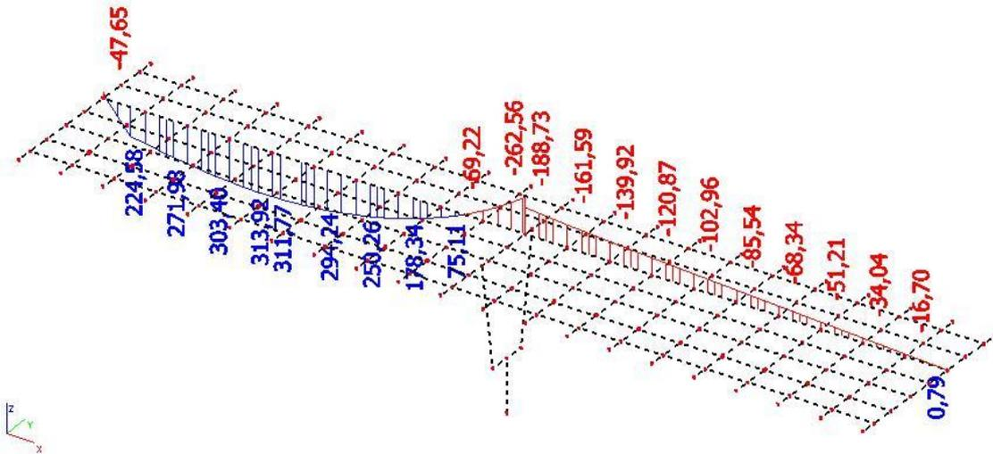
Slika 28 : Pokretno – max. poprečne sile pri upornjaku – momenti ( $M_y$ ) u kNm
