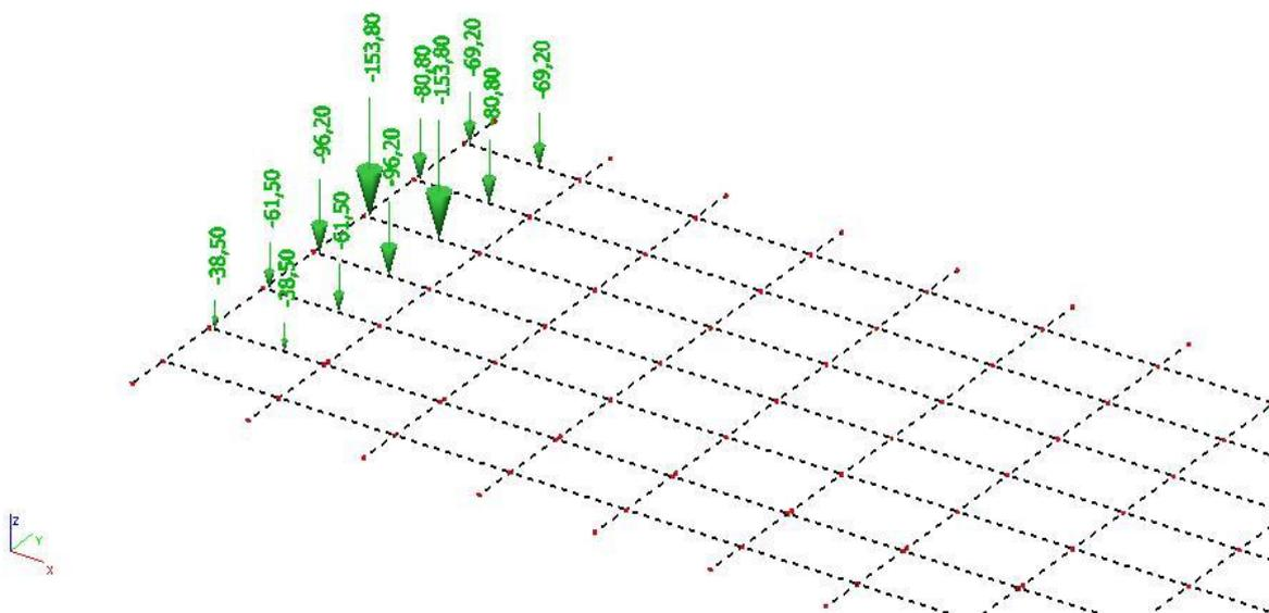
Slika 27 : Prikaz opterećenja tipskog vozila za max. poprečnu silu pri upornjaku
