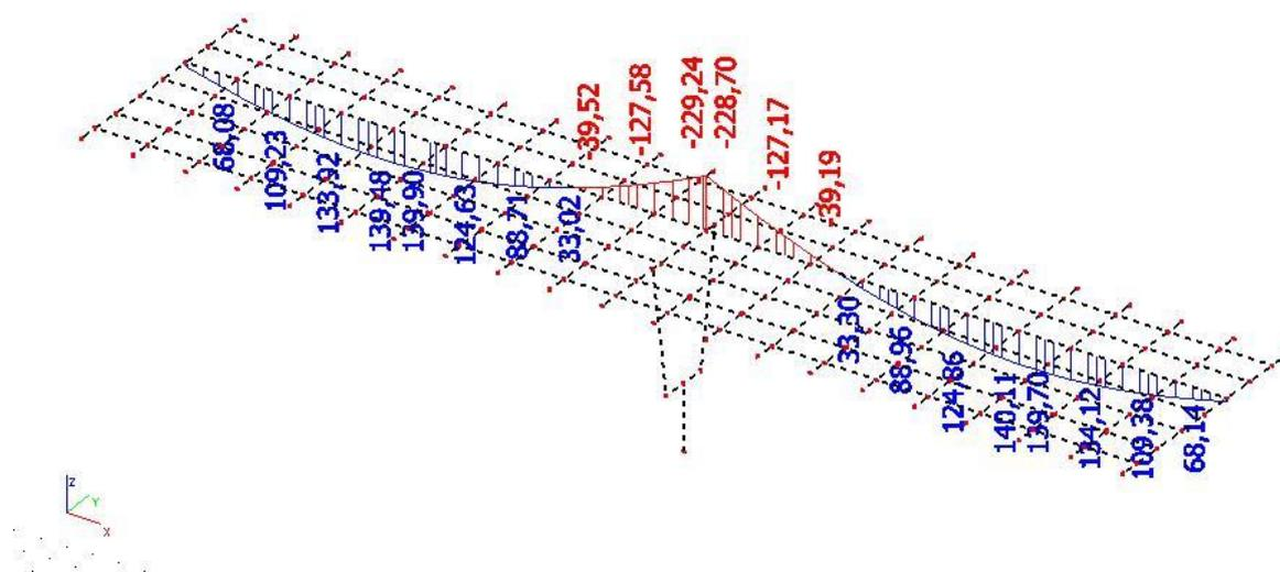
Slika 11: Dodatno stalno - momenti ( $M_y$ ) u kNm
