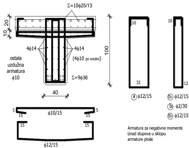
Slika 33 : Prikaz armiranja nosača u presjeku a-a
