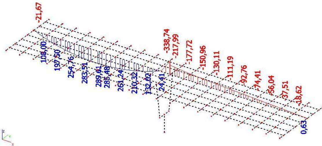
Slika 24 : Pokretno – max. poprečne sile pri stupu - momenti ( $M_y$ ) u kNm
