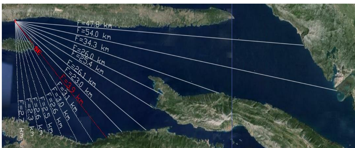
Slika 3.6. Skica za izračun efektivne duljine privjetrišta za centralni smjer SE (135°)
