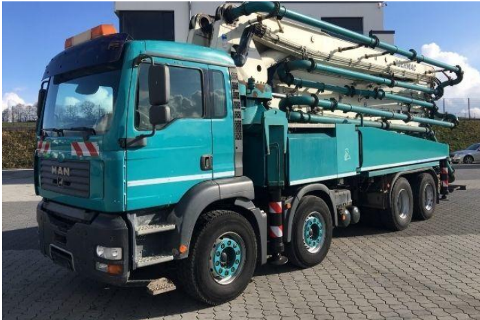
Slika 8. Pumpa za beton MAN JXM 4215 TGA 41.390 [5]
