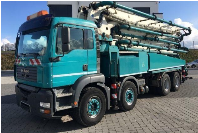
Slika 14. Pumpa za beton MAN JXM 4215 TGA 41.390 [5]
