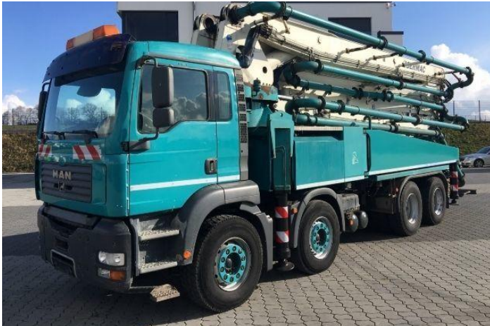
Slika 8. Pumpa za beton MAN JXM 4215 TGA 41.390 [5]
