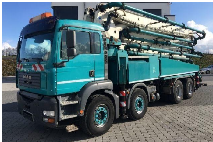
Slika 14. Pumpa za beton MAN JXM 4215 TGA 41.390 [5]
