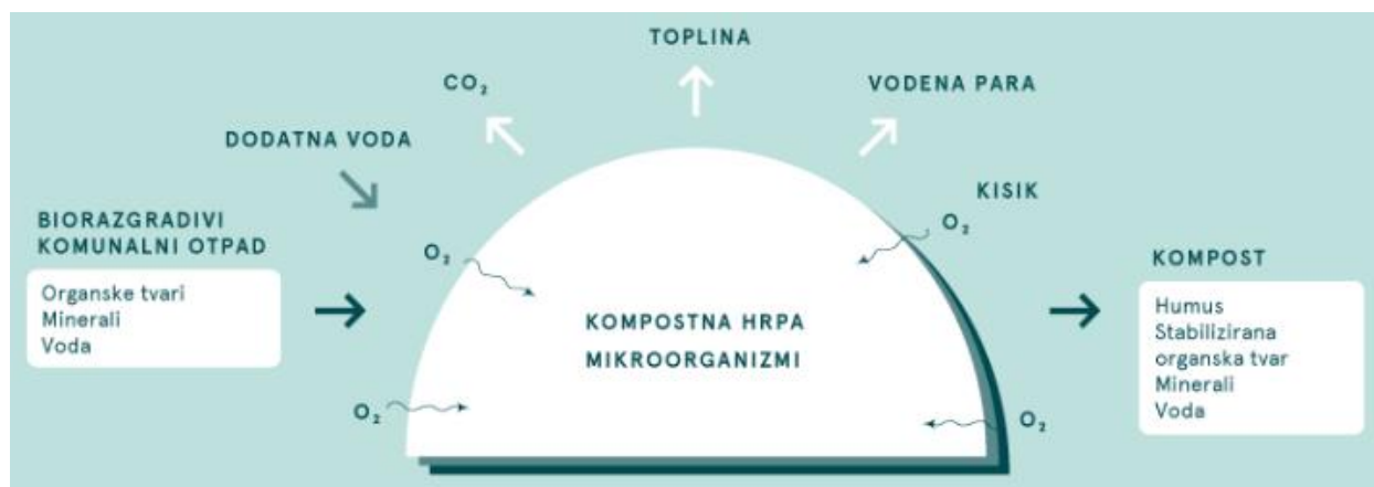
Slika 11.1. Ulazi i izlazi tvari u procesu kompostiranja
