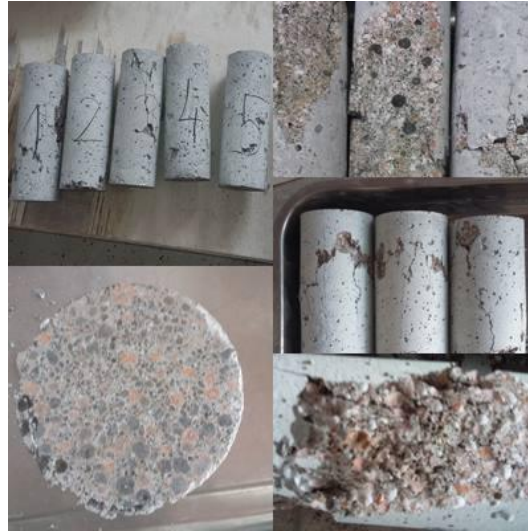
Slika 6.4 Ispitivanje tlačne čvrstoće uzoraka mješavine SCC7 [slika zabilježena tijekom ispitivanja]
