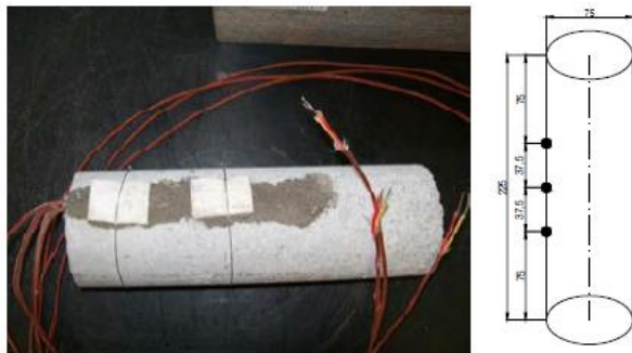
Slika 4.16 Položaj mjernih točaka na uzorku za određivanje tlačne čvrstoće i modula elastičnosti [7]
