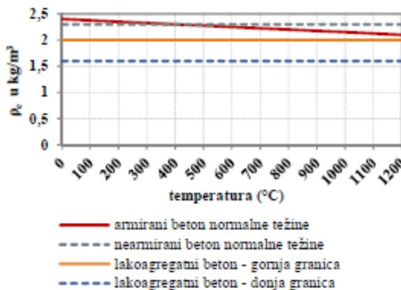
**Slika 3.6** Gustoća betona pri visokim temperaturama [4]
