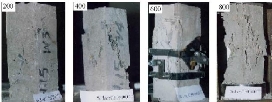
**Slika 4.29** Uzorci lomljene prizme nakon ispitivanja tlačne čvrstoće [8]
