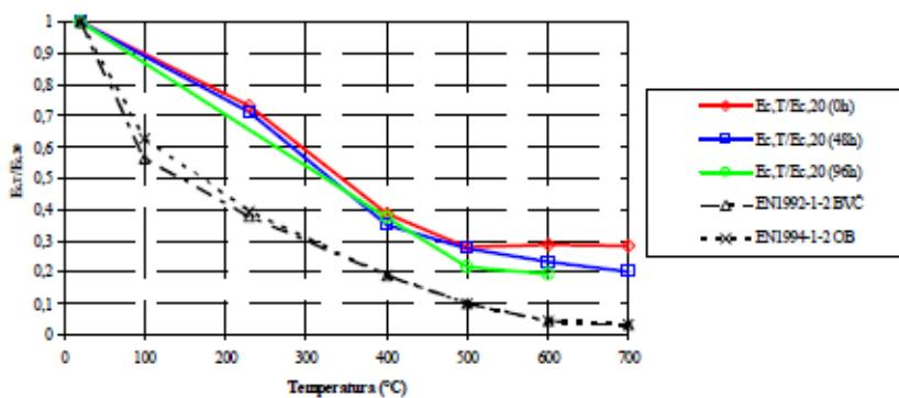
**Slika 4.22** Redukcija tangentnog modula elastičnosti Ec u vremenu i usporedba s EN1992-1-2 i EN1994-1-2: BSČ i BVČ [7]
