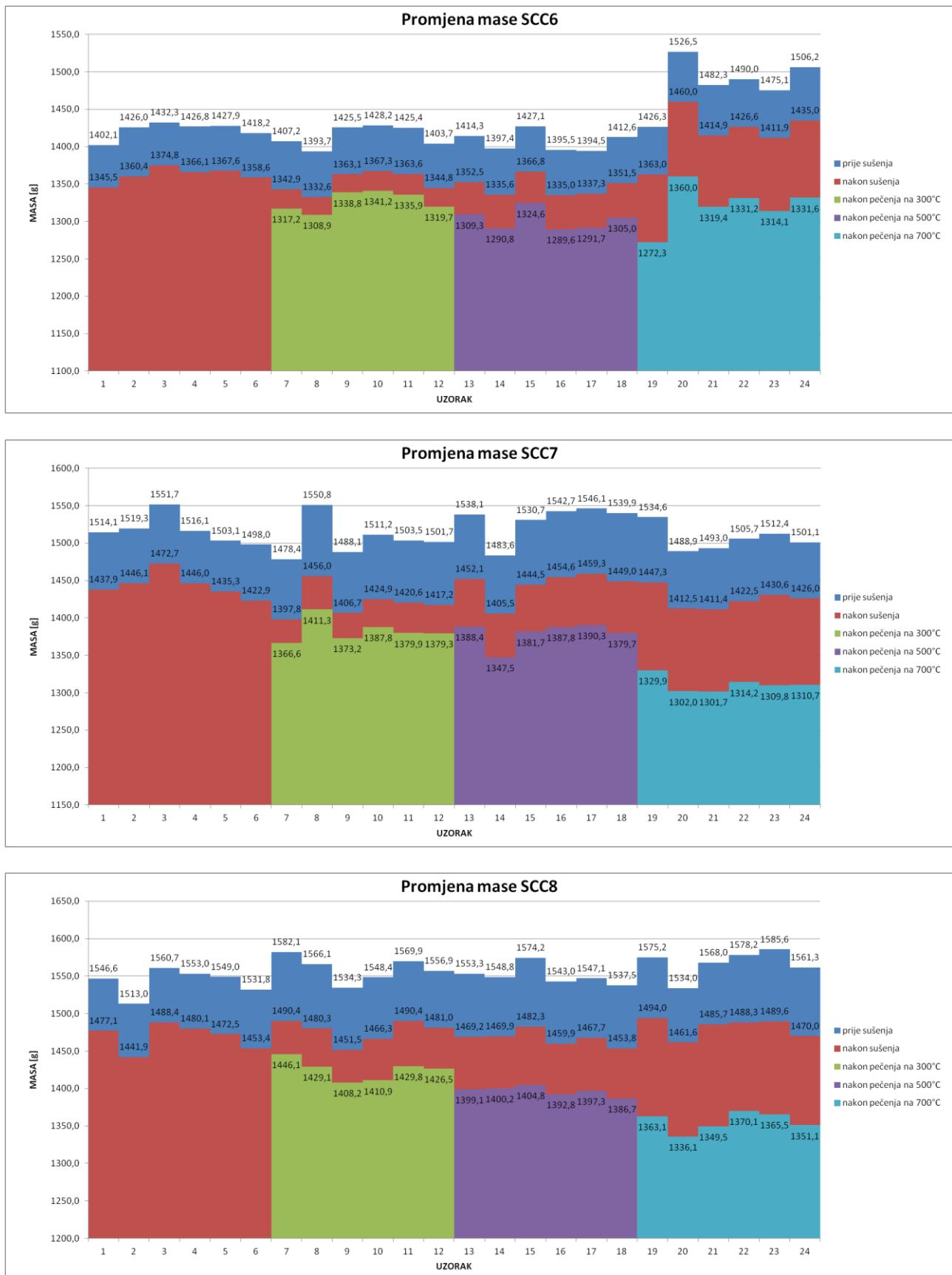
Slika 6.9 Grafički prikaz promjene mase uzoraka po mješavinama
