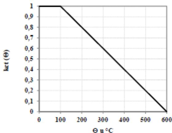
**Slika 3.2** Koeficijent  $k_c(\Theta)$  kojim se uzima u obzir umanjenje vlačne čvrstoće betona,  $f_{ck}$ , pri povišenim temperaturama [4]
