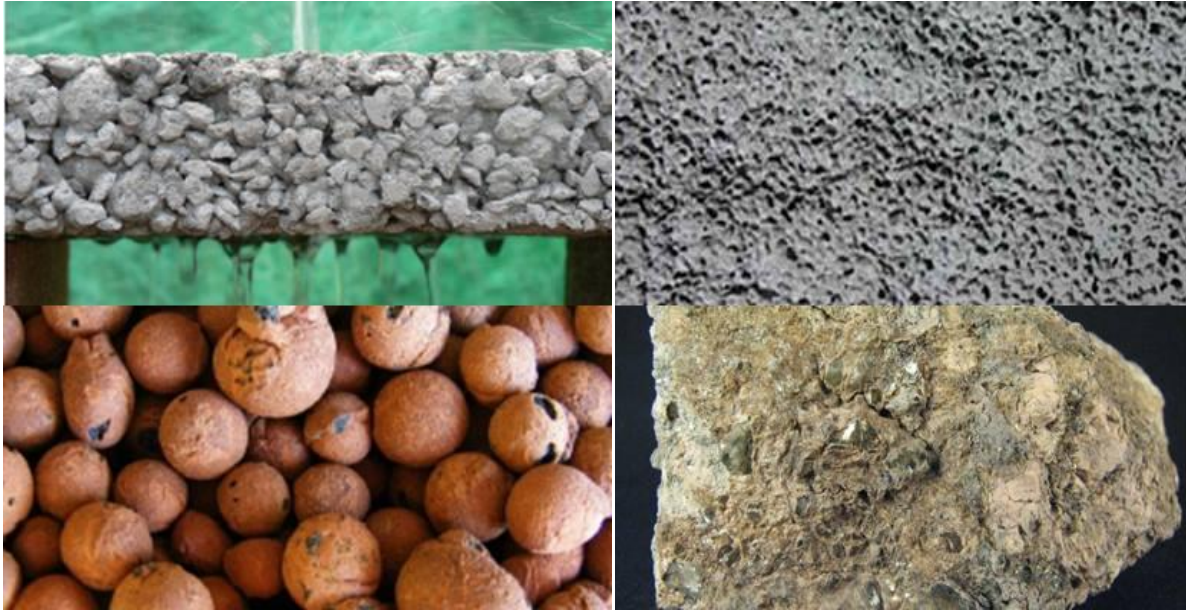
Slika 2.2 Gore: Laki beton od jednakozrnatog agregata, lijevo; Pjenobeton, desno Dole: Granule ekspanzirane gline, lijevo; Vermikulit, desno, izvor [3]
