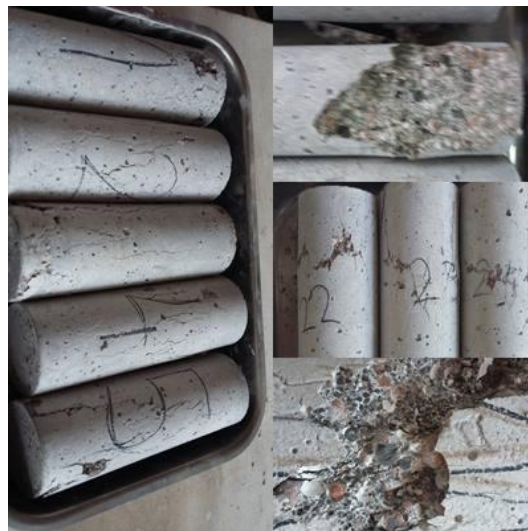
Slika 6.5 Ispitivanje tlačne čvrstoće uzoraka mješavine SCC8 [slika zabilježena tijekom ispitivanja]
