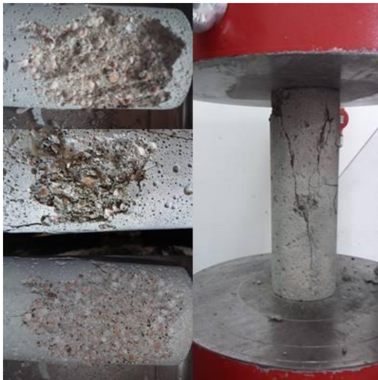
Slika 6.3 Ispitivanje tlačne čvrstoće uzoraka mješavine SCC6 [slika zabilježena tijekom ispitivanja]
