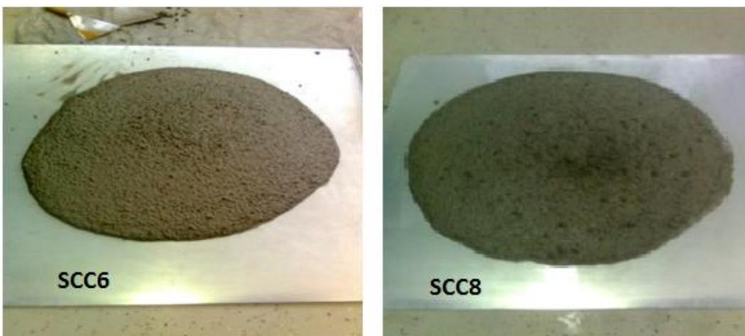
**Slika 5.4** Rasprostiranje- slijeganjem mješavina SCC6 i SCC8 [2]
