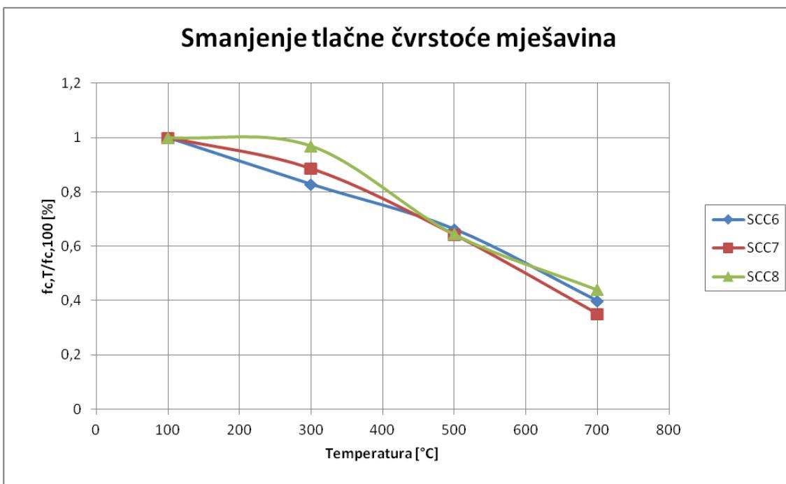
**Slika 6.10** Smanjenje tlačne čvrstoće po temperaturama i mješavinama
