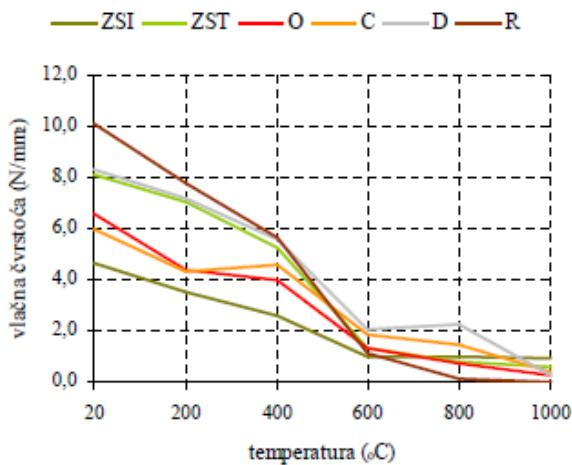
**Slika 4.8** Utjecaj temperature na vlačnu čvrstoću uzorka s različitim agregatima [5]
