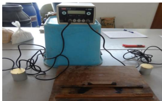
Slika 6.7 Uređaj za mjerenje brzine ultrazvučnih valova [slika zabilježena tijekom ispitivanja]
