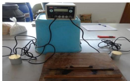
**Slika 6.7** Uređaj za mjerjenje brzine ultrazvučnih valova [slika zabilježena tijekom ispitivanja]
