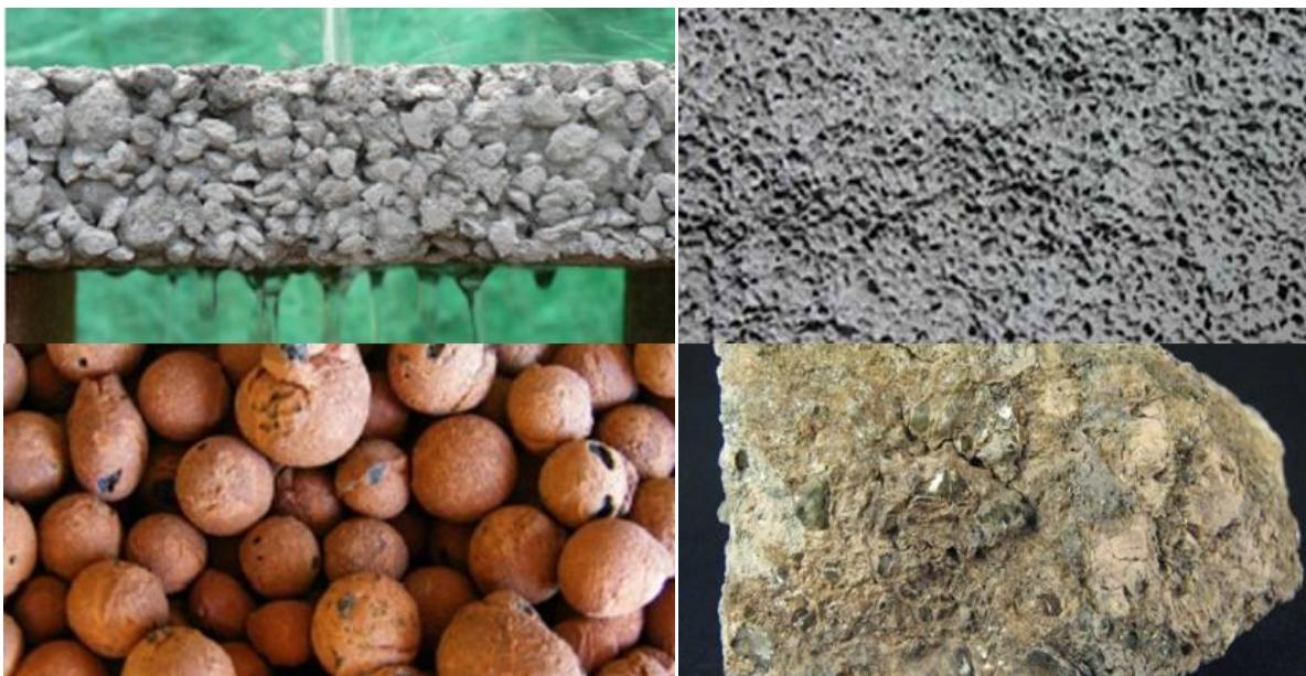
**Slika 2.2** Gore: Laki beton od jednakozrnatog agregata, lijevo; Pjenobeton, desno
