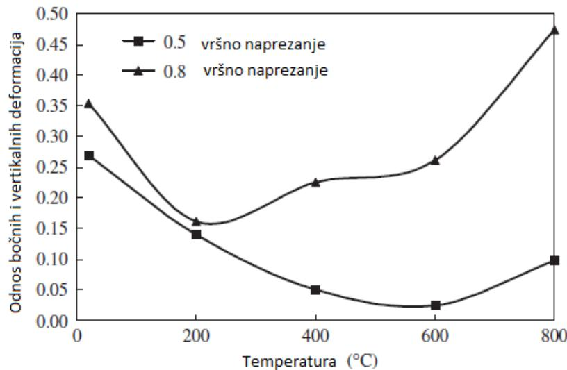
Slika 4.35 Učinci izloženosti uzorka temperaturi na omjer bočnih i vertikalnih deformacija
