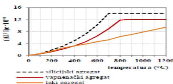
**Slika 3.3** Ukupno toplinsko prodljenje betona [4]
