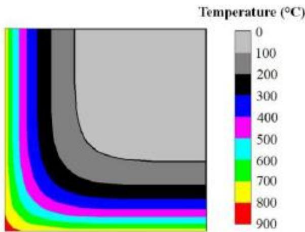
**Slika 4.14** Temperaturno polje u četvrtini stupa nakon 30 minuta ISO požara [6]
