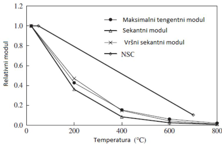
**Slika 4.35** Učinci izloženosti uzorka temperaturi na elastični modul [8]
