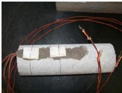
**Slika 4.16** Položaj mjernih točaka na uzorku za određivanje tlačne čvrstoće i modula elastičnosti [7]
