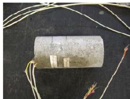
**Slika 4.17** Položaj mjernih točaka na uzorku za određivanje vlačne čvrstoće [7]
