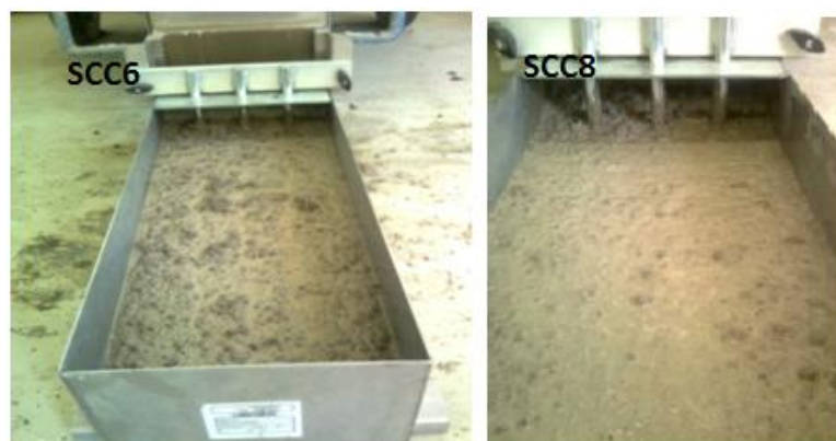
Slika 5.5 Prolaznosti mješavina SCC6 i SCC8 [2]
