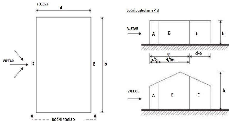
Parametar  $e$ :  $e = b$  ili  $2h$  (odabire se manja vrijednost) = 50 ili 20  $\rightarrow e = 20 \text{ m}$ ;  $e/4 = 5 \text{ m}$ ,  $e/10 = 2 \text{ m}$
